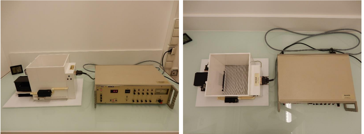
Figure 41: photographie de la boîte d'évitement passif
