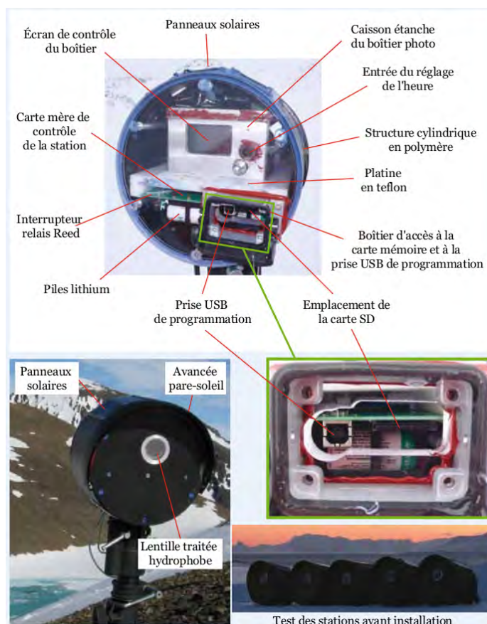
FIGURE 5.5 – La station photo automatique de 3 e génération. Ce système, complexe dans sa conception, est adapté aux conditions difficiles de l'Arctique et dispose d'une autonomie qui lui permet un fonctionnement sans intervention humaine pendant la majorité de l'année. Système mis en place par FEMTO-ST, partenaire du programme HSF. Source : Bernard [Bernard, 2011]
