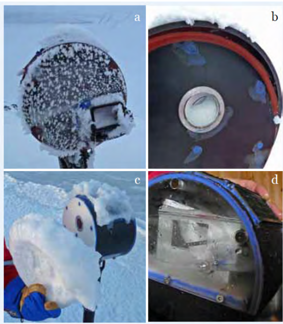
FIGURE 5.12 – Le climat extrême a parfois des conséquences importantes et inattendues sur les stations photo. Du dos arraché au saphir enfoncé (a et b), de la gangue de glace à la station remplie d'eau (c et d), nombreux sont les aléas qui peuvent perturber le bon fonctionnement des appareils photo. Source : Bernard [Bernard, 2011]
