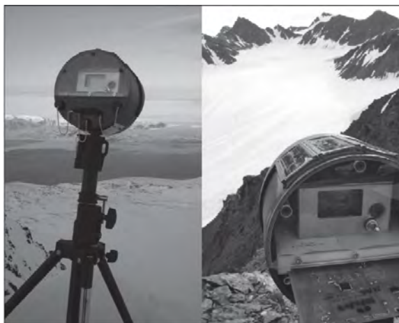
FIGURE 5.10 – Caméra dans sa boîte, avec les panneaux solaire afin d'améliorer la longévité de la batterie de la caméra. Extrait de Laffly [Laffly et al., 2012b]
