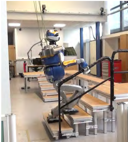
(a) HRP-2 montant un escalier en s'aidant d'une rambarde. Image provenant de [Carpentier 2017c].
