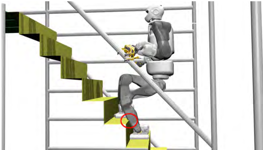
FIGURE 7.26 – Exemple de configuration en collision : la cheville gauche est en collision avec la marche suivante.
