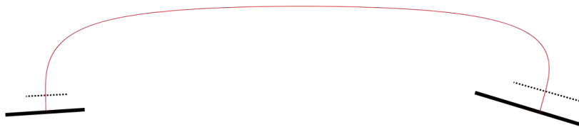
FIGURE 6.4 – Exemple de trajectoire respectant les contraintes imposées. En rouge la trajectoire de l'organe terminal dans le plan (x, z) . En noir en trait plein les surfaces de contact en noir pointillé l'instant où la trajectoire n'est plus contrainte à être colinéaire à la normale de la surface de contact.
