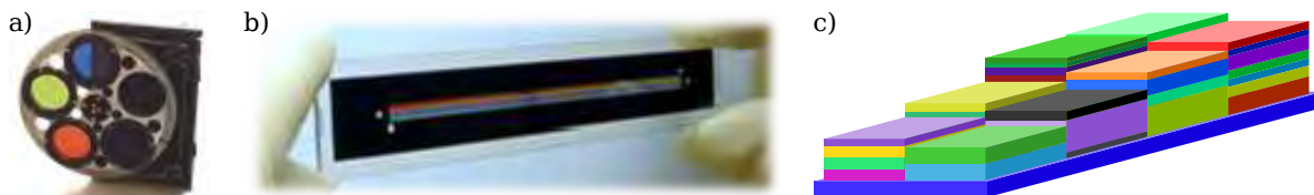
FIGURE 0.1 – Évolution chronologique des technologies de filtrage multispectrales pour les applications spatiales : a) roue à filtres, b) filtre allumette, c) mosaïque de filtres pixellisés.
