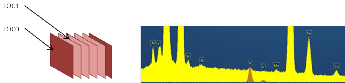
FIGURE 5-27 – Analyse EDX d'un assemblage de bandes laminées et cofrittées à 880 °C
