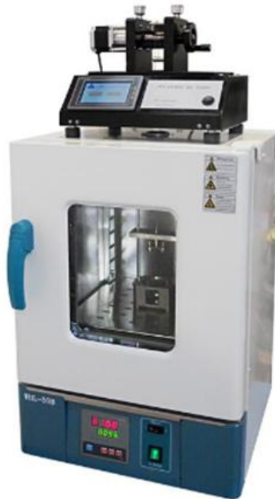
Figure II.6 : Photographie du dispositif de trempage tirage.
