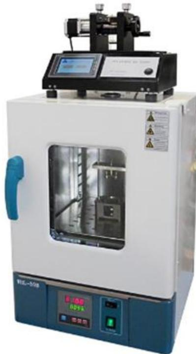
**Figure II.6 :** Photographie du dispositif de trempage tirage.
