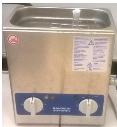
Figure 37 : Bain à ultrasons thermostaté à 30 °C utilisé pour l'extraction assistée par les ultrasons (UAE)
