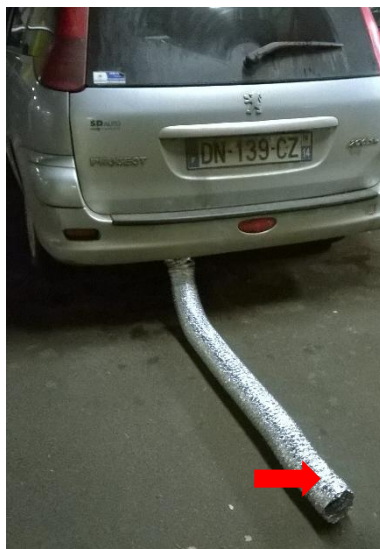
Figure 34 : Montage utilisé pour l'exposition intentionnelle des fruits (30 min) aux gaz d'échappement diesel La flèche rouge indique la localisation des fruits
