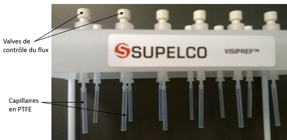
Figure 41 : Photographie de la partie supérieure du montage Visiprep Solid Phase Extraction Vacuum Manifold (Supelco) présentant les valves de contrôle du flux ainsi que les capillaires en polytétrafluoroéthylène (PTFE)
