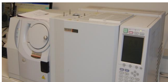
Figure 42 : Chromatographe en phase gazeuse (GC) et spectromètre de masse quadripolaire (qMS) utilisés pour l'analyse des extraits contenant des HAP et des BTEX
