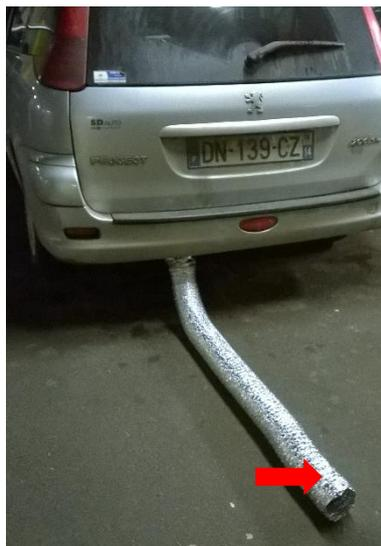
**Figure 34 : Montage utilisé pour l'exposition intentionnelle des fruits (30 min) aux gaz d'échappement diesel**
