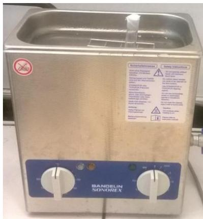
Figure 37 : Bain à ultrasons thermostaté à 30 °C utilisé pour l'extraction assistée par les ultrasons (UAE)
