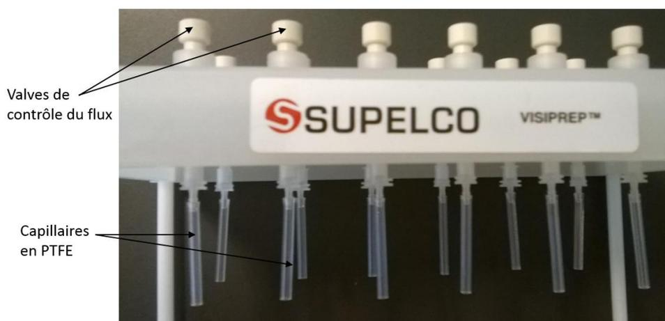
Figure 41 : Photographie de la partie supérieure du montage Visiprep Solid Phase Extraction Vacuum Manifold (Supelco) présentant les valves de contrôle du flux ainsi que les capillaires en polytétrafluoroéthylène (PTFE)
