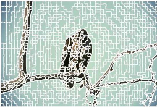
(a) Image 42049 de BSD. Nombre de superpixels : 472. Taux d'erreur de sur-segmentation : 0,03. Taux de rappel sur les contours : 0,99.
