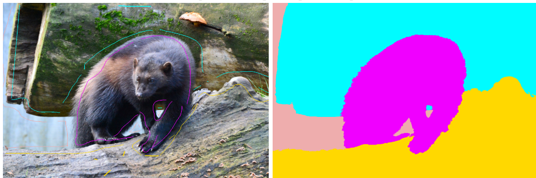
(b) Utiliser des superpixels n'empêche pas de segmenter avec précision la fourrure du glouton. Quelques erreurs sont cependant visibles au niveau de la patte avant gauche dont la couleur se confond avec l'ombre. Ces erreurs sont commises au niveau des superpixels et ne peuvent pas être corrigées même en ajoutant des germes.
