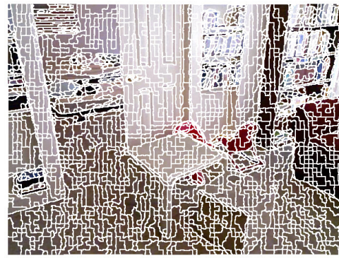
(b) Image 00001315 de NYU. Nombre de superpixels : 905. Taux d'erreur de sur-segmentation : 0,07. Taux de rappel sur les contours : 1.
