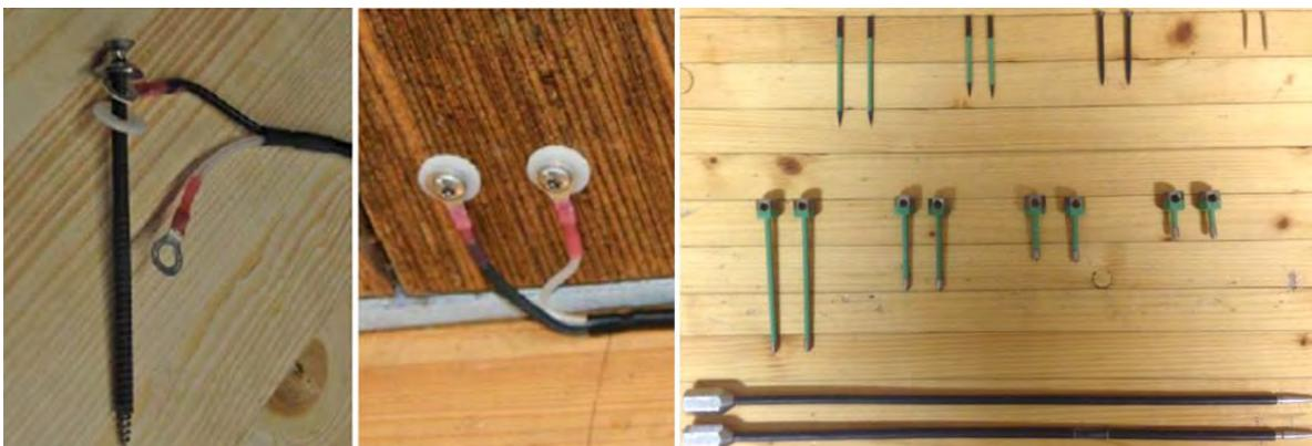
**Figure 75: Electrodes de mesure utilisées pour le suivi de l'humidité dans des ouvrages d'art en bois (Franke et al. 2013b; Dietsch et al. 2014a)**
