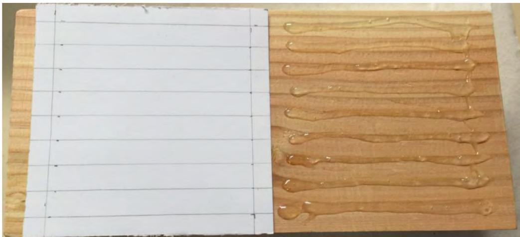
Figure 99: Application de la colle polyuréthane pour le collage des échantillons LC
