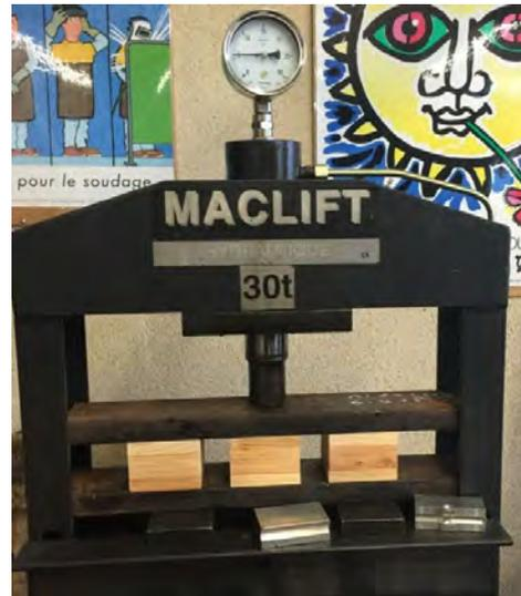
Figure 98: Presse hydraulique pour le collage des échantillons LC (MACLIFT 30t)
