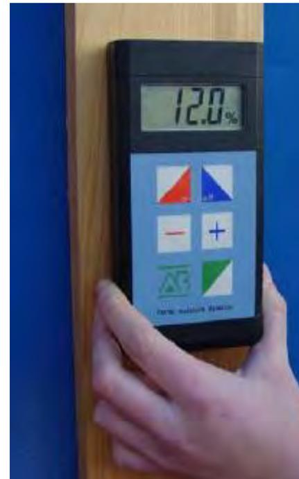
**Figure 49: Mesure de l'humidité du bois avec un humidimètre capacitif (Source : [www.brookhuis.com](http://www.brookhuis.com))**
