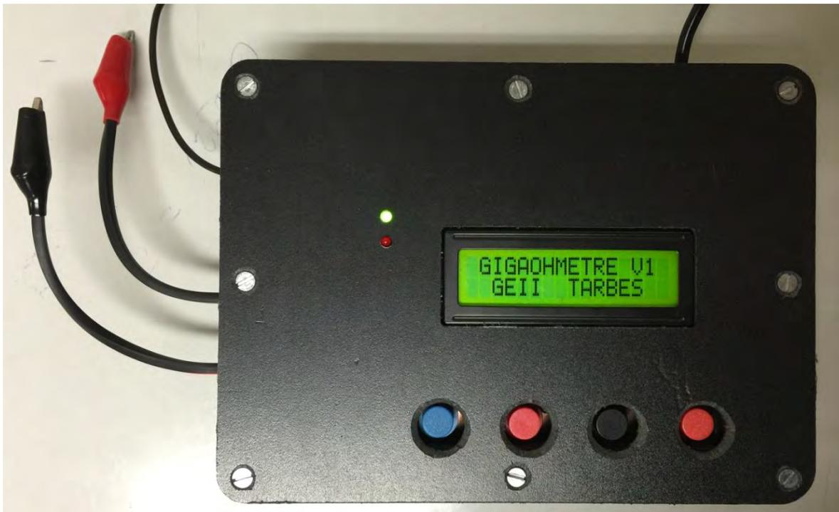
Figure 203: Giga-Ohmmètre
