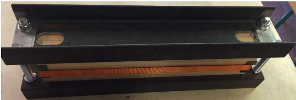
**Figure 173: Montage de serrage utilisé pour les mesures ultrasonores**
