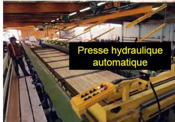
**Figure 30: Serrage sur le banc de collage (Source : Entreprise MATHIS)**
