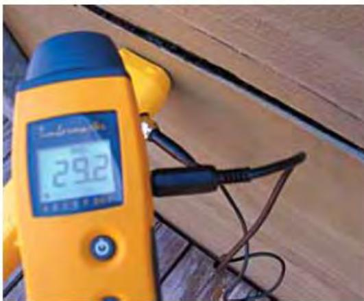
Figure 7: Fente très ouverte due au retrait du bois et induisant une humidité localement élevée (LCPC 2008)
