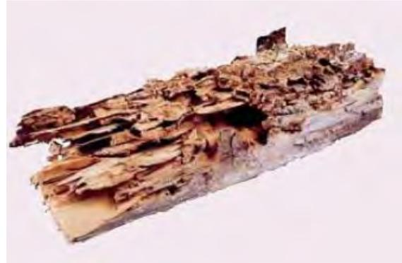
**Figure 13: Dégâts dus à des termites (LCPC 2008)**
