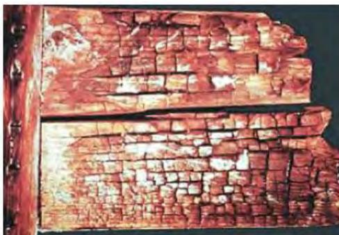
Figure 10: Exemple de dégradation fongique (pourriture cubique) (SETRA 2006)
