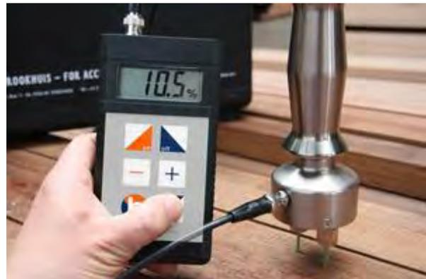
**Figure 41: Mesure de l'humidité du bois avec un humidimètre résistif (Source : [www.brookhuis.com](http://www.brookhuis.com))**
