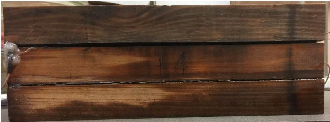
**Figure 202: Délamination sur la totalité de l'interface d'un échantillon LC utilisé pour le suivi de l'humidité par mesures ultrasonores**
