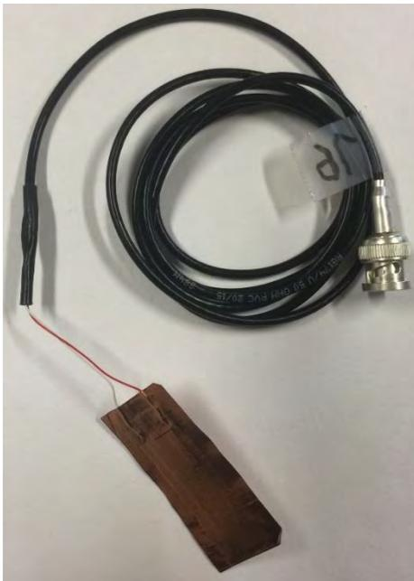
**Figure 169: Câblage du capteur MFC M4010**
