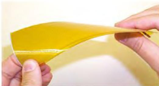
**Figure 83: Capteur AFC (Priya et al. 2008)**
