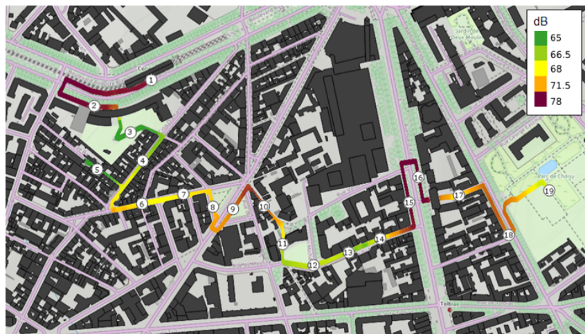
FIGURE 4.7 – Parcours réalisé avec les 19 points de mesures avec le niveau sonore mesuré équivalent.
