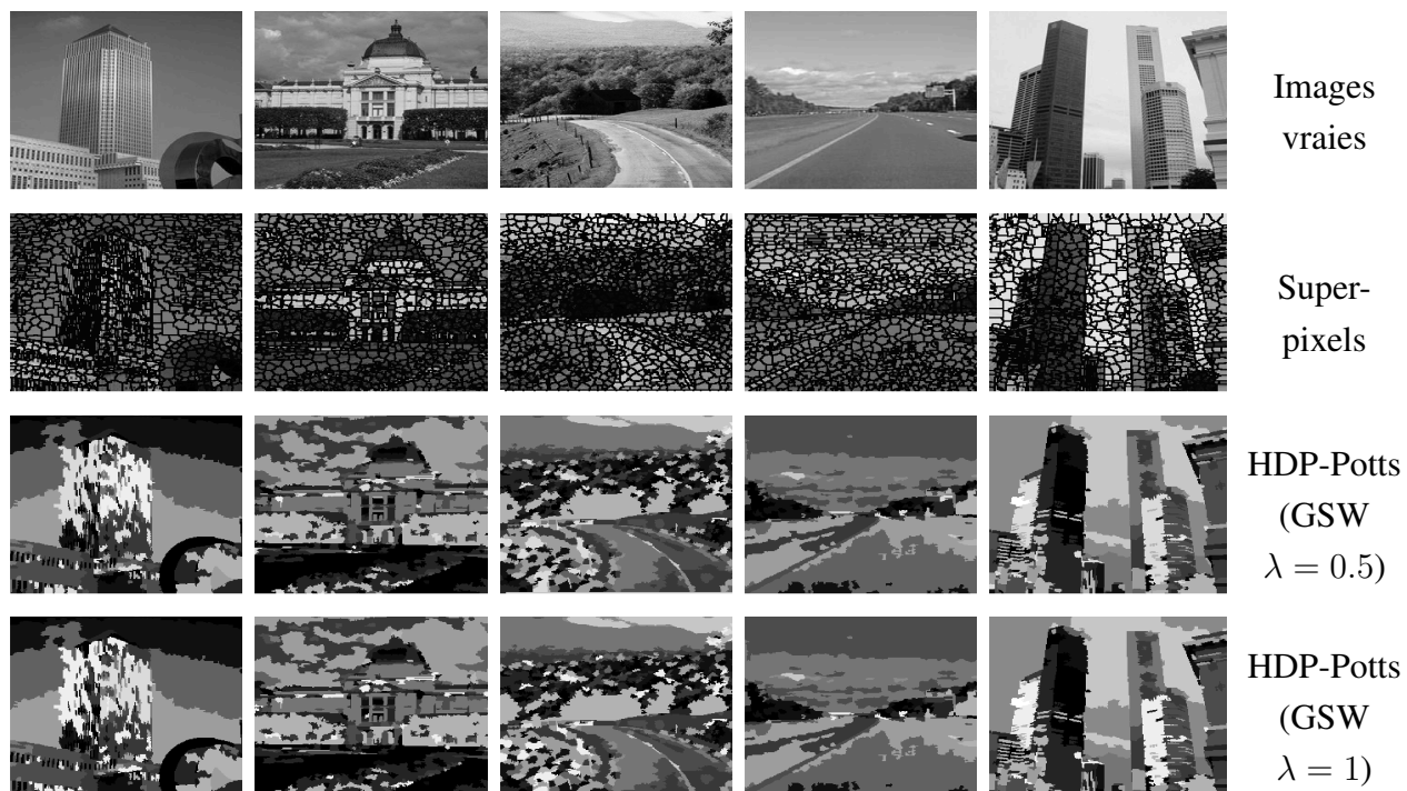
FIGURE E.18 – Sur la première ligne, les images vraies, sur la seconde les images sur-segmentées avec la méthode SLIC pour un nombre de super-pixels approximatif de 1000 dans chaque image. Sur les suivantes les résultats de segmentation obtenus avec l’algorithme de Swendsen-Wang généralisé pour \lambda = 0.5 et \lambda = 1 appliqué au HDP-Potts.
