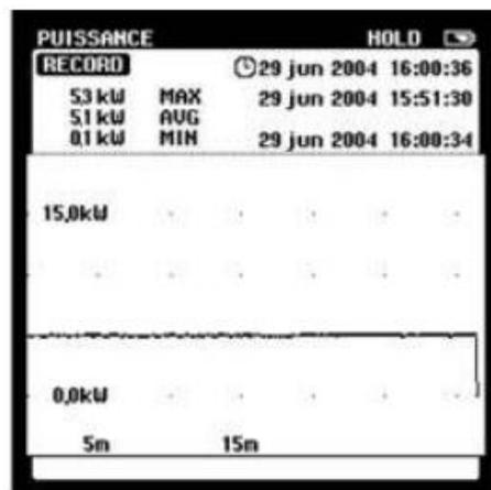
Figure 2.14 - Relevé de la puissance consommée dans le bac à ultrason (Mognol2006)
