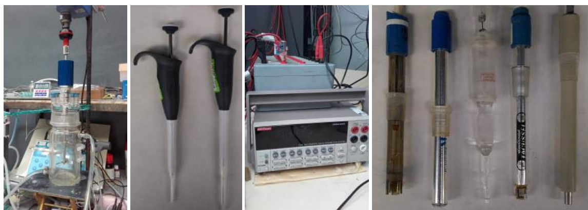
FIGURE 2.6 – Appareillage complet pour les essais de cinétique de réduction. De gauche à droite : réacteur de 1 L en verre borosilicaté à double paroi avec moteur d'agitation et triple hélice d'agitation; pipettes à déplacement positif; centrale d'acquisition Keithley 2700; électrodes de mesure du pH, du potentiel redox, électrode de référence, électrode de conductivité et électrode de température.
