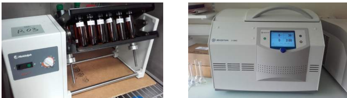
FIGURE 2.4 – Appareillage utilisé pour les essais de solubilité. A gauche, l'agitateur vertical; à droite, la centrifugeuse Sigma 3-30 KS.
