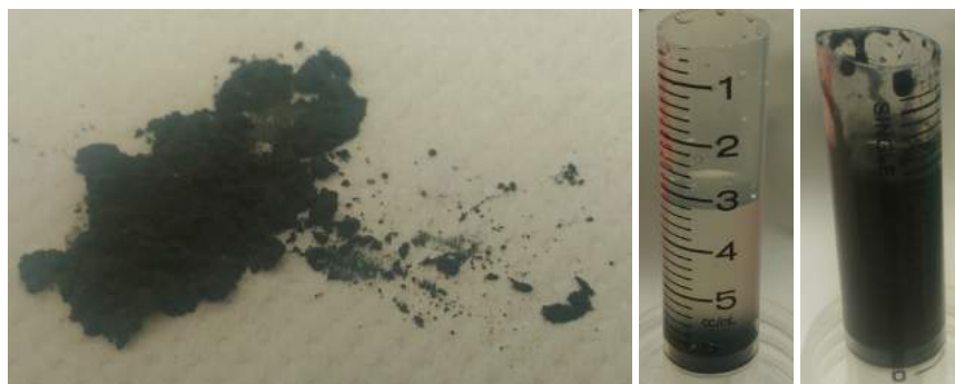
FIGURE B.5 – Photo du réactif choisi, avec de gauche à droite les microparticules de Pd/Fe seules (BioCAT B), la solution d'acide polylactique seule et la suspension des microparticules de Pd/Fe dans l'acide polylactique.
