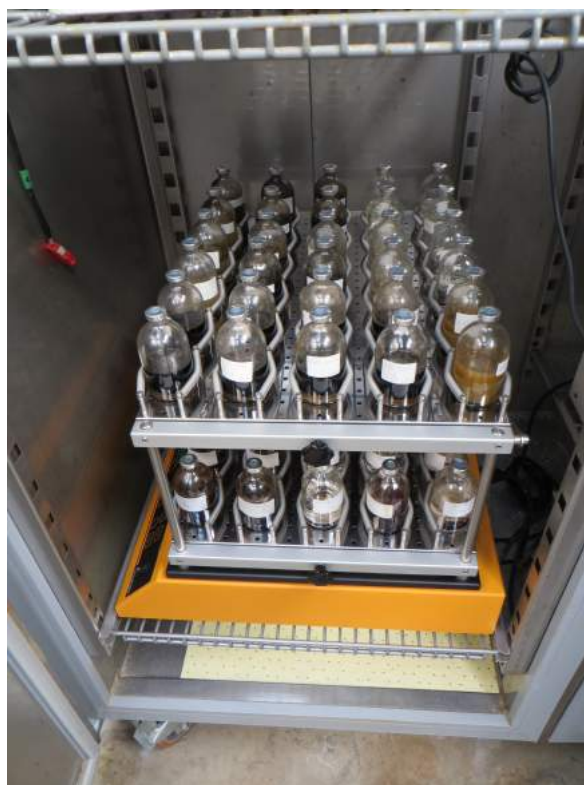
FIGURE 2.5 – Flacons de 100 mL placés sur une table d'agitation dans une enceinte thermorégulée.
