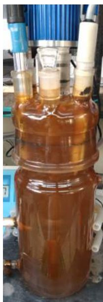
FIGURE D.2 – Photo du réacteur après 24 heures de réaction à 25 °C en présence de 600 mg de microparticules de Pd/Fe, 850 mg de PLA et [HCBD]_0 = 38,5 \mu\text{mol} \cdot \text{L}^{-1} . La solution est initialement incolore, et devient progressivement noire lors de l'introduction et dispersion de la suspension de microparticules de fer. Ici, la couleur orange indique la présence de rouille dans le réacteur.
