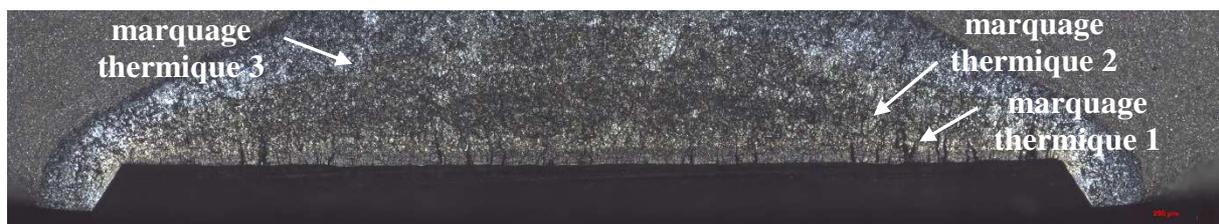
**Figure B-32 – Amorçage de fissure à partir d'anomalies de surface de type choc**
