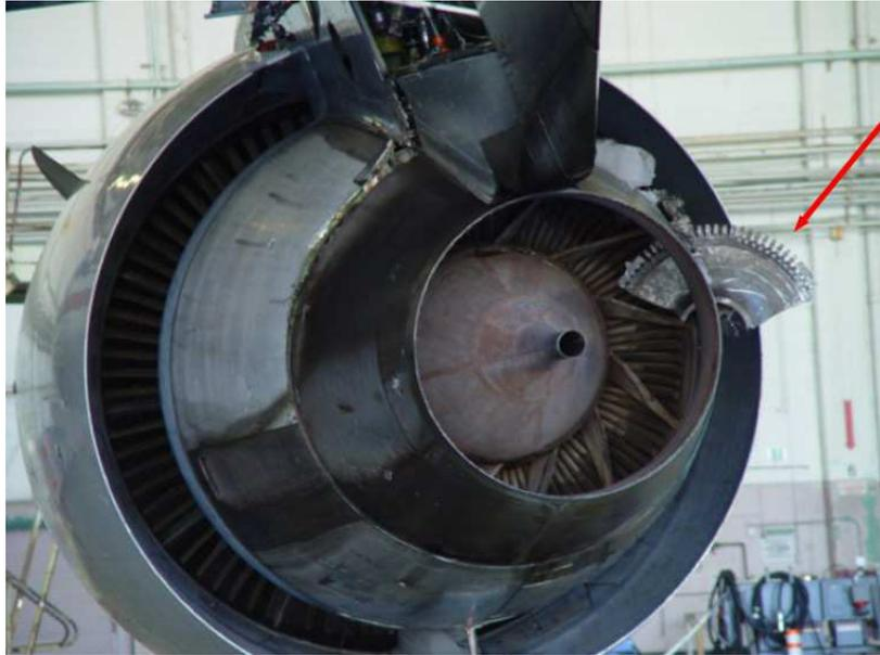
**Figure 2 – Photo d’un disque de turbine éclaté - American Airlines N330AA
