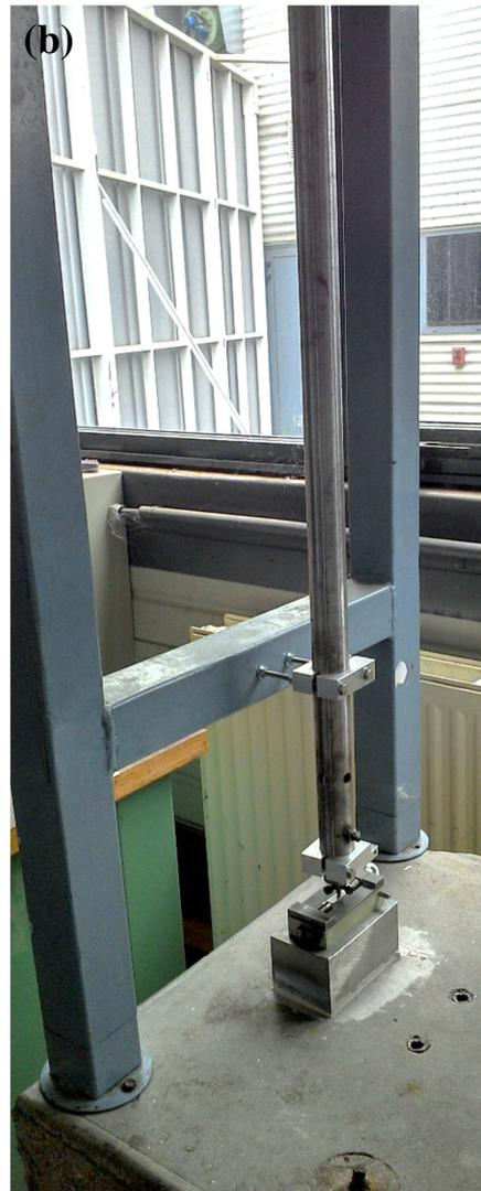
Figure A-13 – (a) Plan de l'outil en carbure utilisé, (b) vues global du montage choc et (c) du montage de fixation permettant le maintien de l'éprouvette lors de la réalisation des chocs
