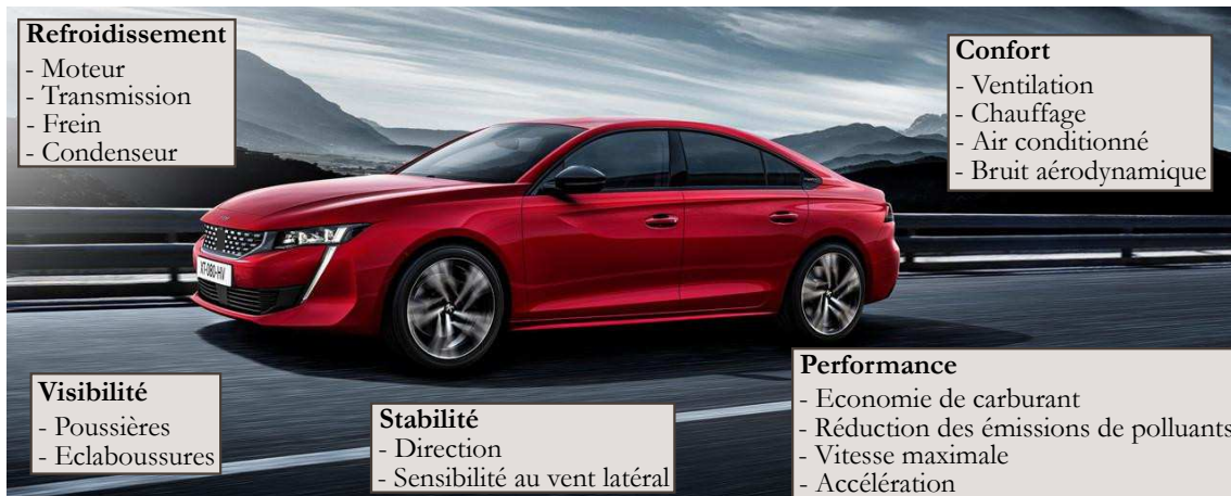
FIGURE 2.1: Critères agissant en grande partie dans le cahier des charges des études aérodynamiques. Données reprises de Hucho (1998) .
