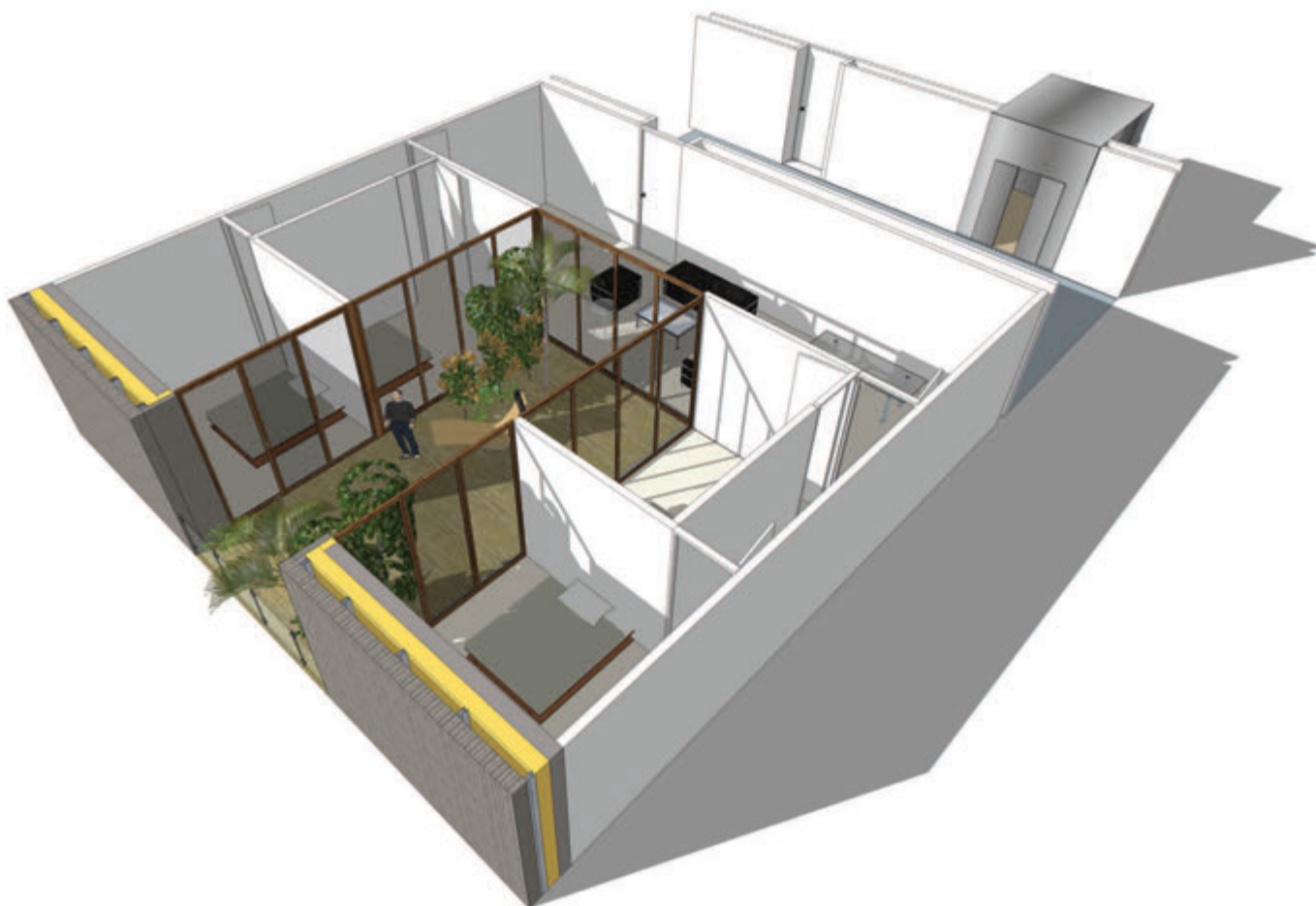
Figure A7-2- Proposition initiale du concept BaityKool : Logement collectif sans fenêtres directes vers l'extérieur. Crédit : Équipe BaityKool - Solar Decathlon Middle East 2018
