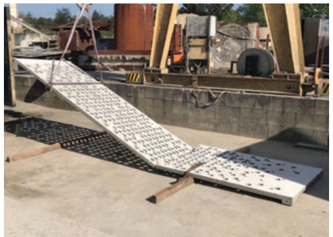
Photos A7-2-Solar Decathlon Middle East 2018 - Equipe Baitykool : Essais sur l'enveloppe en BFUP Avril-Juillet 2018 Crédit : FYu - Solar Decathlon Middle East 2018
