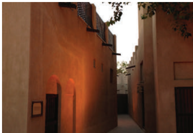
Photo 1-39 Rapport très intime entre façades portant l'ombre l'une sur l'autre à Dubaï. Crédit : FYu
