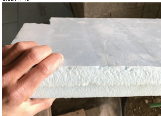
Photo 1-197 Epaisseur de l'isolation en XPS utilisé pour les parois en contact avec la terre. Crédit : FYu
