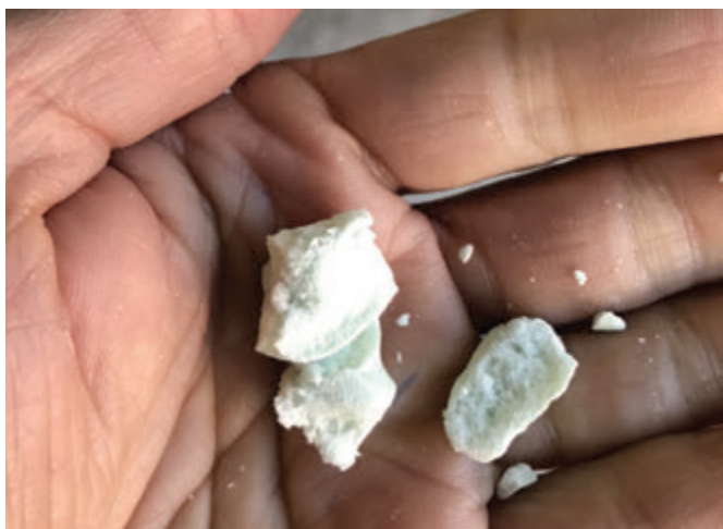
Photo 1-194 Isolation en Bio-Polyurethane . Crédit : FYu
