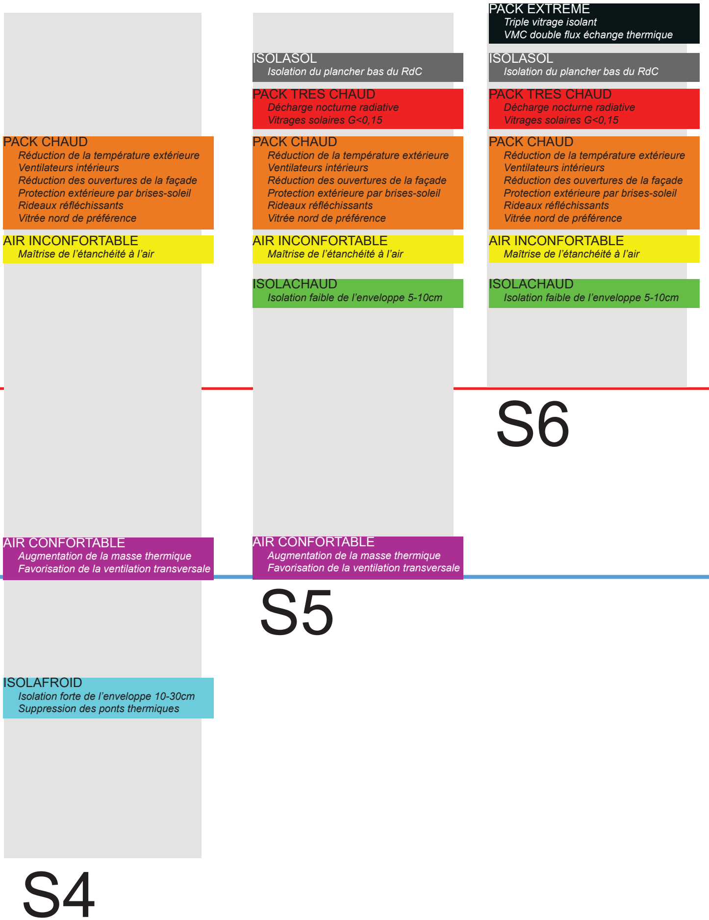
Figure 6-3 Schéma de la méthode consolidée des actions architecturales associées aux saisons climatiques suite aux résultats des modélisations des actions
