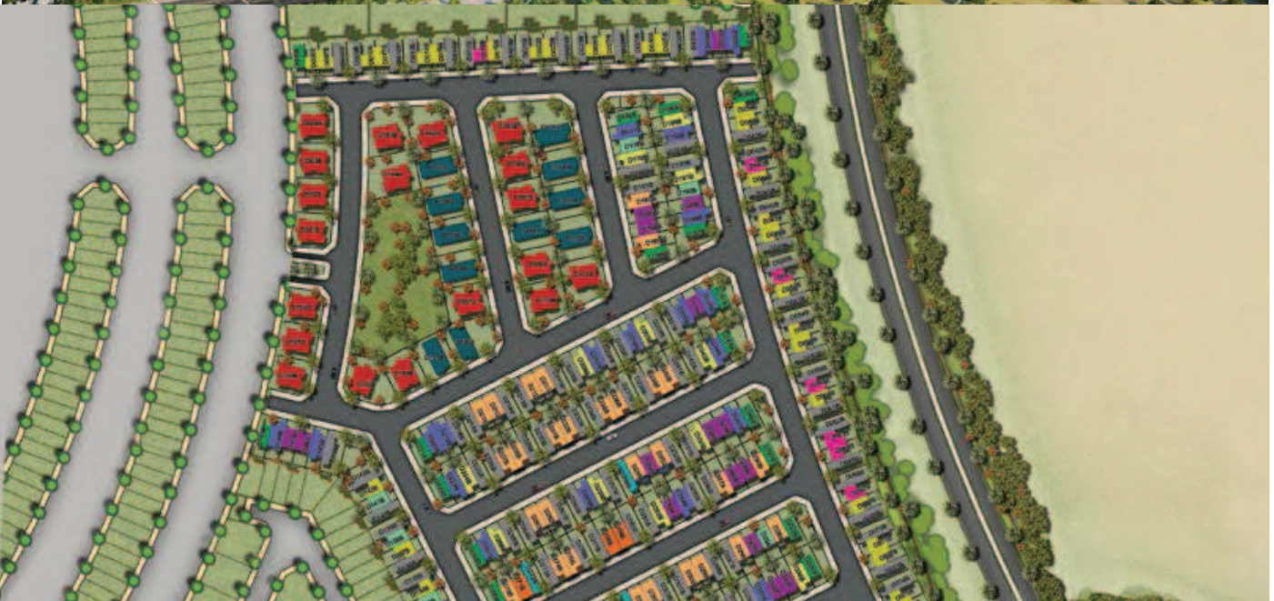
Figure 4-31 Plan urbain de l'opération AKO 2 YA OXIGEN à Dubaï proposé et en construction par la société DAMAC avec une prise en compte de l'orientation uniquement dans l'organisation des dessertes du lotissement, et pas en rapport avec le soleil.
