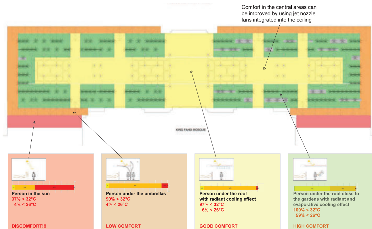
Figure 2-35 caractérisation de plusieurs zones d'un lieu en fonction du confort ressenti dans l'heure la plus chaude de la journée pendant les 365 jours d'un an. Crédit: Transsolar et PolyRhythmic Architecture
