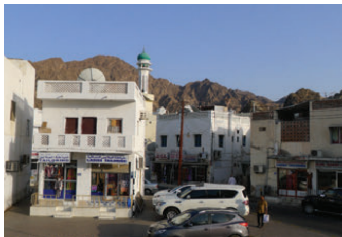
Photo 1-52 Façades blanches et avec des ouvertures avec des filtres visuelles par grillage en maçonnerie et casquettes. Crédit : FYu
