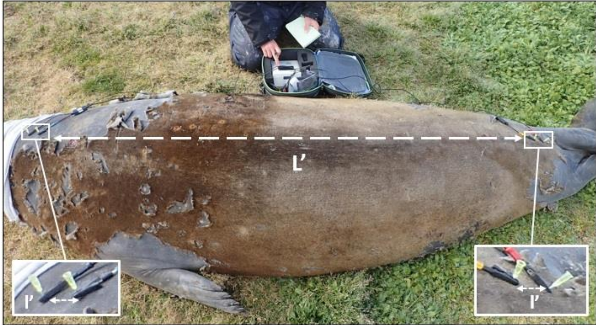
Figure 15 Placement des électrodes lors d'une mesure test de bio-impédancemétrie, avec « L' » la distance entre les deux aiguilles centrales (entrée comme longueur du corps lors de la mesure) et « l' » la distance séparant les aiguilles deux à deux à la tête et à la queue. « L' » est identique à la capture et à la recapture et l' = 6 cm.
