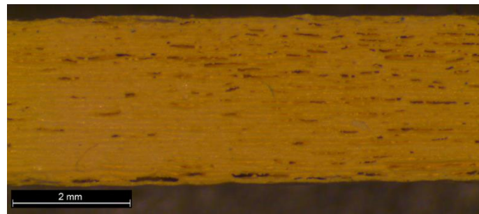
Figure IV.16. Microscopie d'une pièce en Comp 1200 vue de côté
