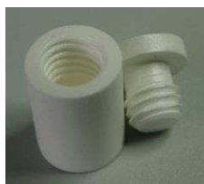
Figure II-3 : Creuset cylindrique en nitrure de bore utilisé pendant les expériences RMN HT de diamètre externe 9 mm et de hauteur 14 mm.
