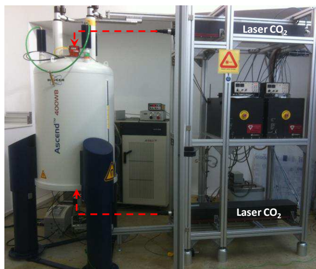
Figure II-4 : Montage expérimental RMN à haute température.
