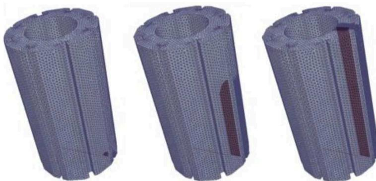
(c) Propagation de fissure à angle  $\beta$  imposé à zéro.
