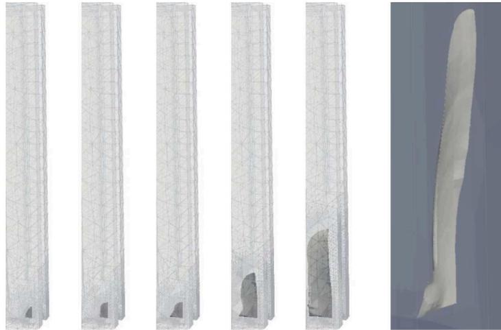
(a) Propagation de fissure où l'angle  $\beta$  est calculé par le *maximum hoop stress criterion*.
