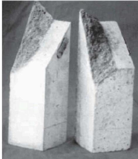
FIGURE 1.15 – Faciès de rupture observé expérimentalement (d'après [Bro96]).
