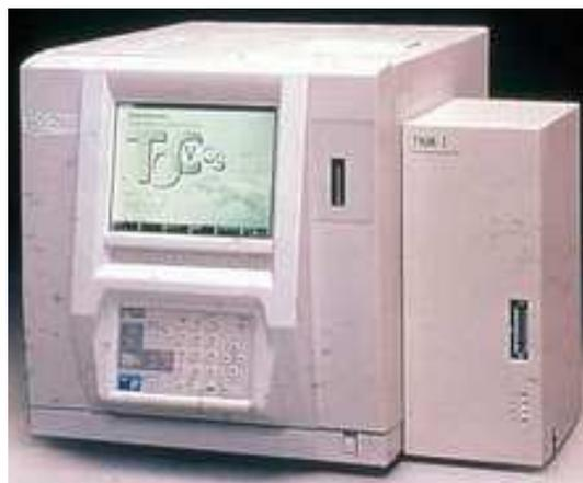
**Figure II.14.** Appareil de mesure de carbone organique dissous Shimadzu TOC-V CSN
