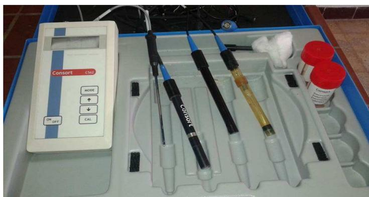
**Figure 3.1. Analyseur (mallette) multiparamétrique**
