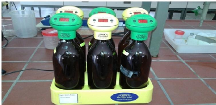
**Figure II.13.** DBO mètre OxiTop®
