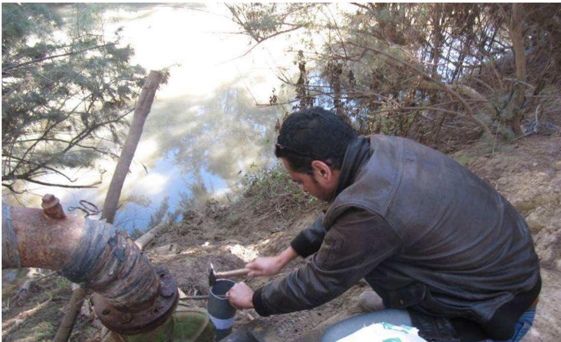
**Figure II.10.** Technique de carottage des sédiments
