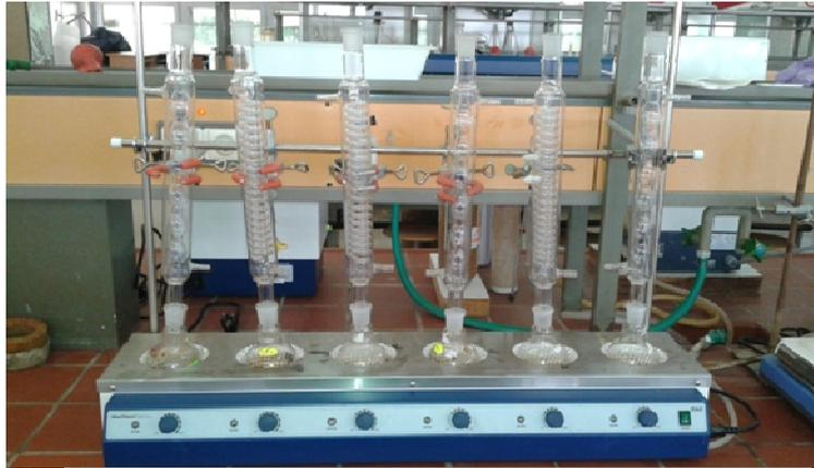
**Figure II.12.** Montage expérimental pour la mesure de la DCO
