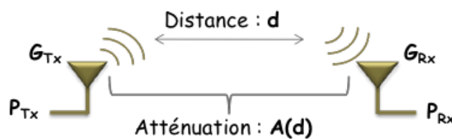
FIGURE 1.13 – Schéma du bilan de liaison.
