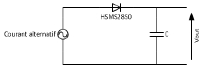
FIGURE 3.5 – Schéma de circuit de conversion RF-DC série
