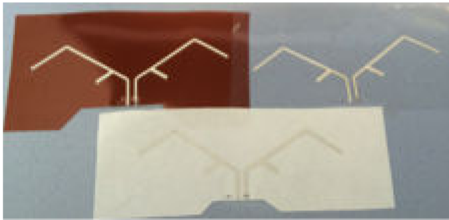
FIGURE 2.34 – Photo de l'antenne Eagle réalisée sur Kapton®, PET et papier.
