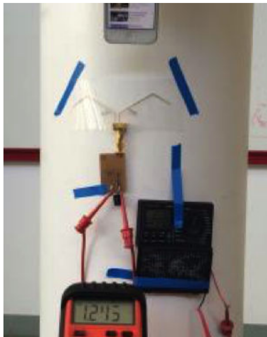
FIGURE 4.15 – Télé-alimentation à partir d'un smartphone d'une horloge en utilisant un récupérateur hybride sur un poteau.
