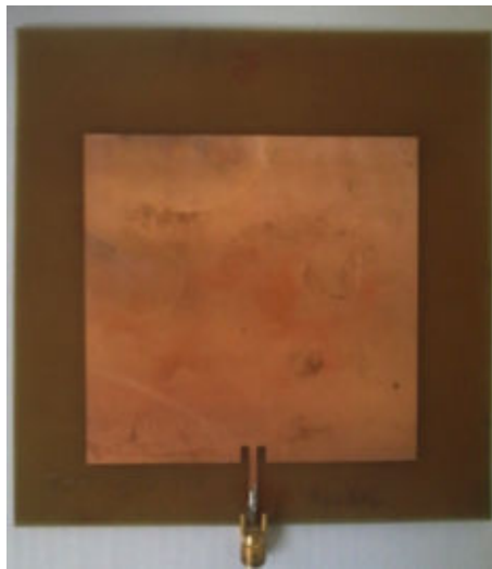
FIGURE 2.13 – Photo de l’antenne patch 900 MHz obtenue par gravure chimique.
