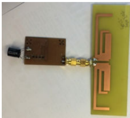
FIGURE 4.8 – Photo de la rectenna utilisant l’antenne dipôle tri-bandes.
