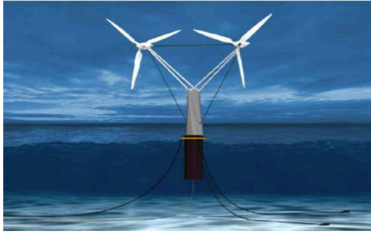
FIGURE 4.1 : Structure SEREO [30] composée de deux turbines.
