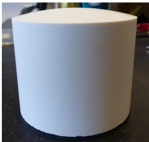
Figure 2.5-12 Bloc d'octoviton de densité 1,86 après usinage
