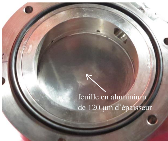
Figure 2.6-3 Collage d'une fine feuille d'aluminium à la surface de l'explosif
