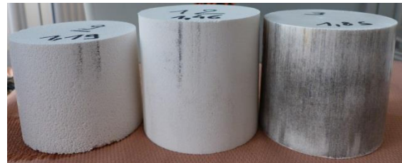
Figure 2.3-3 Echantillons d'octoviton de densité 1,19 (droite), 1,47 (centre) et 1,86 (gauche)
