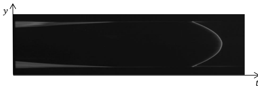
Figure 2.5-7 Mesure de la courbure du front de détonation pour l'octoviton de densité 1,86 (n°ZD16036)
