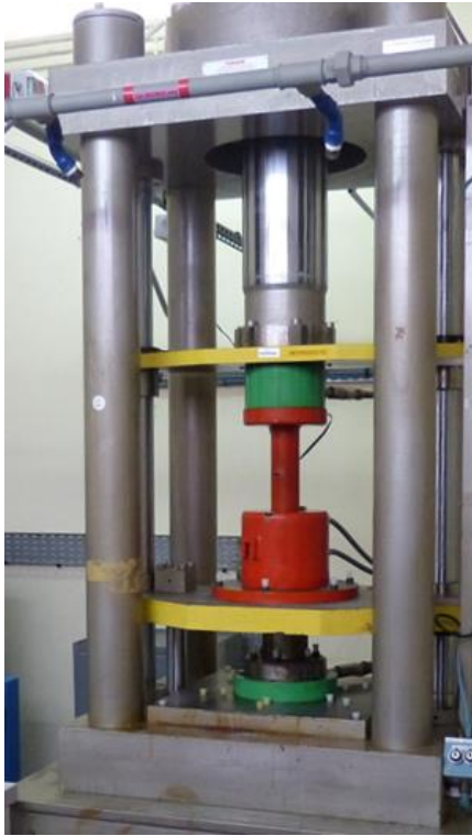
Figure 2.3-1 Presse 300 tonnes du CEA/Gramat
