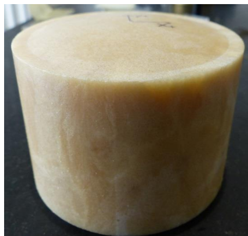
Figure 2.5-13 Bloc de Composition B après usinage
