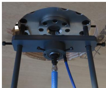
Figure 2.5-2 Vue de dessous : support de la tête optique pour la mesure de spectrométrie
