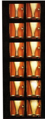
Figure 2.2-12 Expansion d'un cylindre en cuivre (Carion & Servas, 1992)
