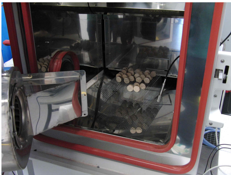
Figure 1 – Chambre climatique SECASI contenant un lot d'échantillons de contreplaqué de bouleau circulaires
