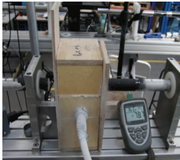
Figure 11 – Enceinte climatique pour dispositif SHPB, fermée au moyen de deux plaques de contreplaqué, en refroidissement
