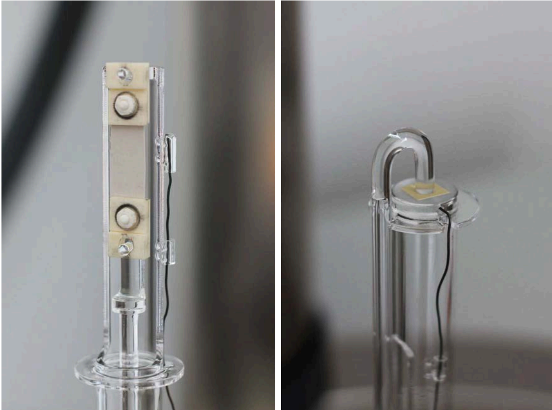
(a) Montage de mesures de dilatations thermiques en tension. Le montage est adapté aux mesures dans le plan des films minces.
