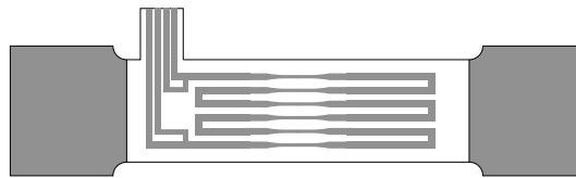
FIGURE 3.32 – Éprouvette de fatigue avec système de mesure de résistance quatre fils.
