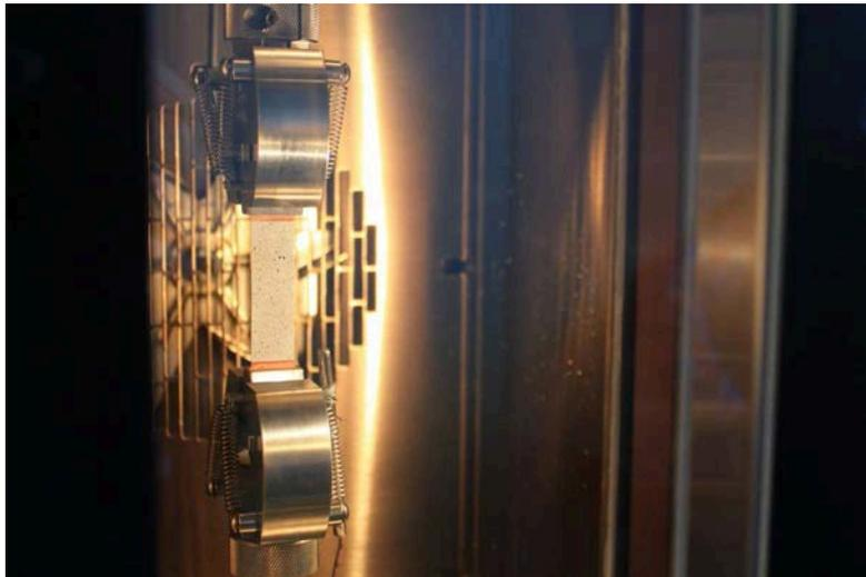
FIGURE 2.8 – Éprouvette en traction dans l'enceinte climatique.
