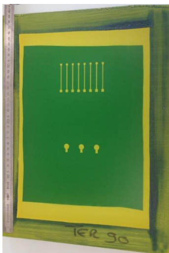
Figure A-2 : Photographie d'un pochoir de sérigraphie.
