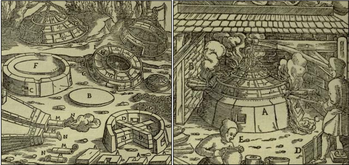
Figure 146 : Gravures tirées du De re metallica présentant le four de coupellation. À gauche, vue éclatée du four et détails des différents éléments. À droite, four en cours de fonctionnement.
