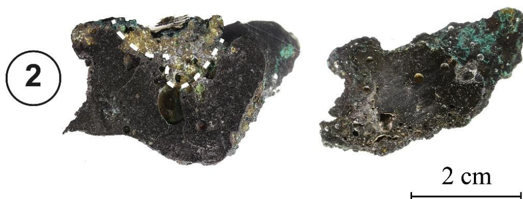
Figure 211 : Sections polies de deux scories de la seconde catégorie. La ligne en pointillés marque la séparation entre la scorie et la bournonite en cours de transformation.
