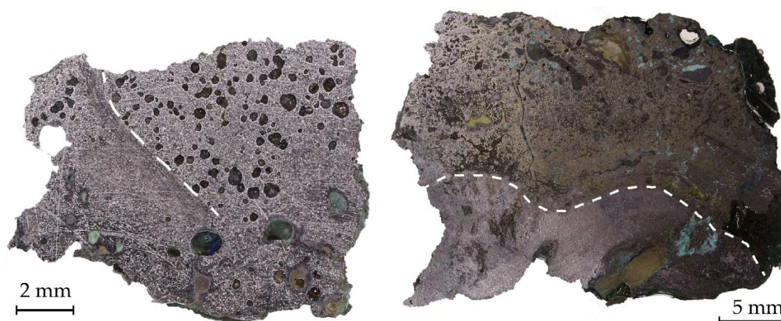
Figure 213 : Sections polies des mattes CL 12490_1 et CL 12826. La ligne en pointillés délimite la zone bulleuse et la zone compacte. On distingue des inclusions de scorie et de gangue dans la partie supérieure de l'individu CL 12826.
