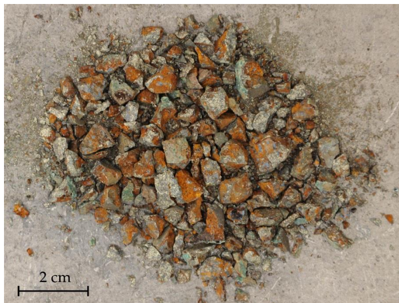
Figure 95 : Échantillon de la chalcoppyrite CL 11809. La couleur rouille indique la présence d'oxydes et d'hydroxydes de fer.
