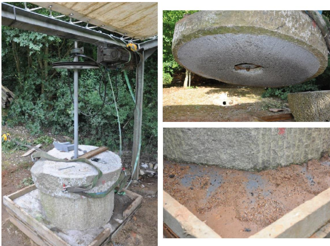
Figure 80 : moulin à minerai expérimental (gauche) ; meule allante en cours de surfaçage (en haut à droite) ; mouture récupérée à l'issue du broyage (en bas à droite) : la poudre de galène (gris) est bien visible.
