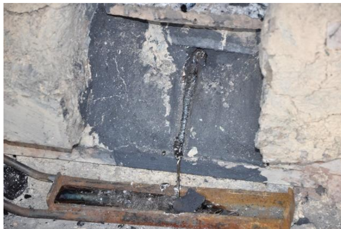
Figure 132 : Coulée de plomb à l'issue d'une expérimentation.
