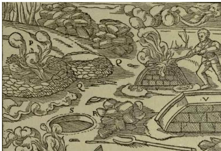
Figure 127 : Tas de charbon sur lequel est placé le minerai dans la procédé westphalien (gauche) ; foyer surélevé doté de plans inclinés du procédé polonais (droite). D'après Hoover H. C. et Hoover L. H., Georgius Agricola De re Metallica... , op. cit. , p. 393.
