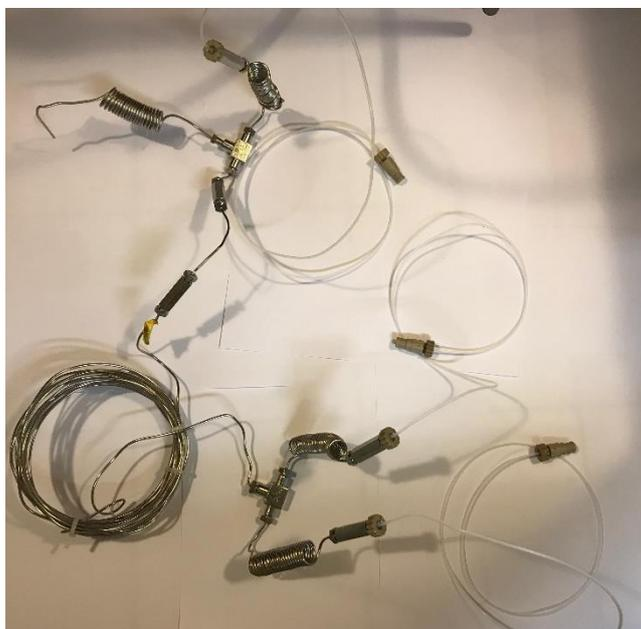
**Photo 1.** Système microfluidique permettant l'alkylation d'oxazolidinones tertiaires par mémoire de chiralité
