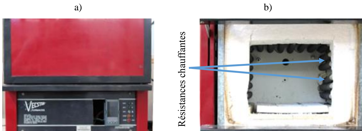
Figure 64 : Vue d'ensemble du four de chauffage. a) Extérieur du four ; b) Éléments chauffants du four à résistances
