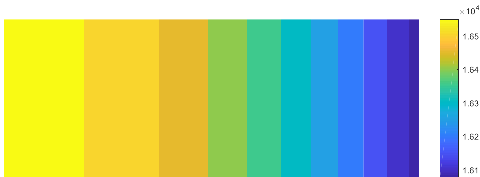
Figure 42 : Distribution radiale de la radiation incidente G^k dans le disque pour \kappa^k = 1 \text{ m}^{-1}
