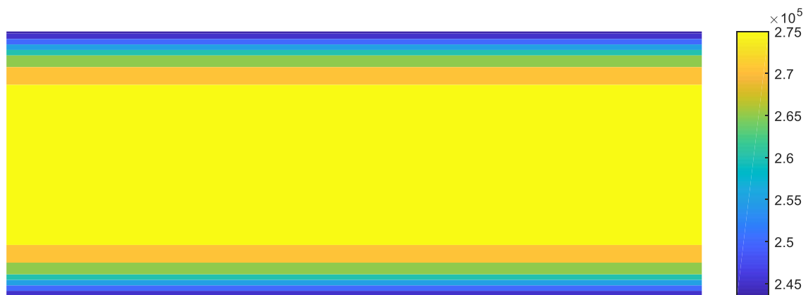
Figure 45 : Distribution de G^k dans le disque pour le Back Ray Tracing avec \kappa^k = 1000 \text{ m}^{-1}
