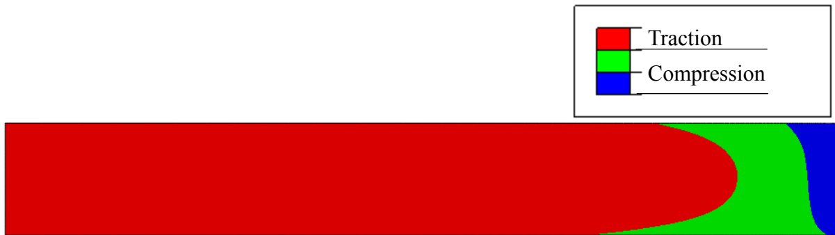
Figure 85 : Distribution du champ de contraintes circonférentielles résiduelles dans le verre refroidi avec le disque d'acier
