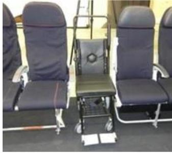
**Figure 1.9.** Situation de transfert dans une cabine d'avion, la chaise de bord (au centre) est obligatoirement positionnée parallèle au siège d'avion à cause du couloir étroit
