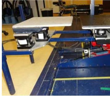
**Figure 2.4.** La surface d'appui pour la main droite vue de face, deux barres verticales reposent au sol, deux barres horizontales s'insèrent dans deux tubes fixés à la surface d'assise
