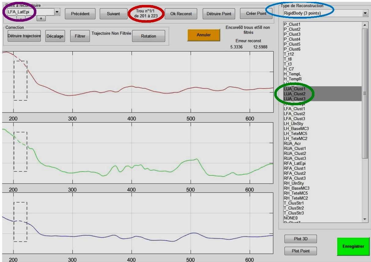
Figure 2.20. Reconstruction d'une coupure de trajectoire par corps rigide (ellipse bleue). Marquer épicondyle latéral gauche (ellipse violette), trou de 22 images (ellipse rouge), les trois marqueurs du cluster sur l'humérus sont utilisés pour reconstruire la trajectoire coupée (ellipse verte)
