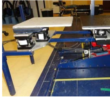
Figure 2.4. La surface d'appui pour la main droite vue de face, deux barres verticales reposent au sol, deux barres horizontales s'insèrent dans deux tubes fixés à la surface d'assise
