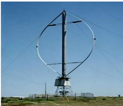
Figure 1-6 Eolienne à axe vertical de type Darrieus [17].
