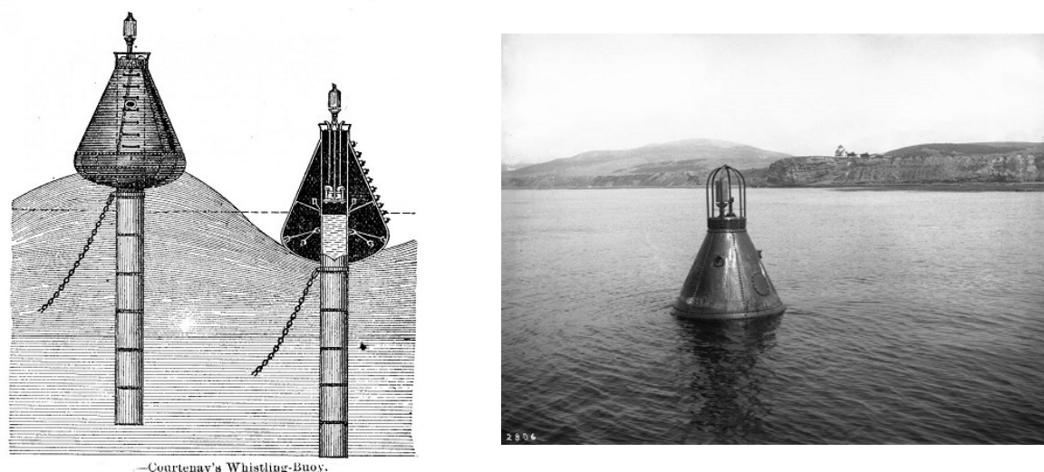
FIGURE 1.4 – Schéma représentatif de la bouée sifflante de Courtenay (à gauche), et cliché d'un dérivé de cette machine à Point Fermin, San Pedro, réalisé en 1890 (à droite) (California Historical Society Collection).
