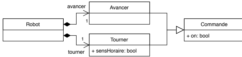
Figure 3.2 – Diagramme de classes du modèle interne de la télécommande de contrôle du robot.
