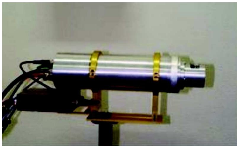
FIGURE 2.2. – Scintillateur BC501A utilisée à AMANDE pour la mesure du temps de vol
