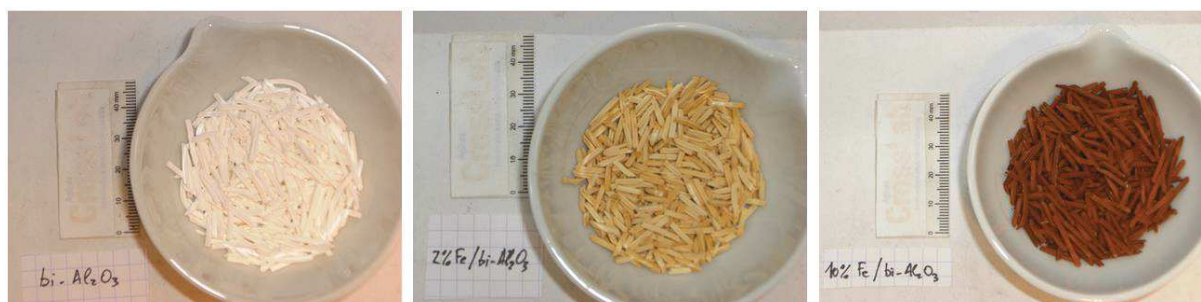
Figure 91 : Impact de l'imprégnation du fer sur l'aspect des pellets de bi-Al 2 O 3 . Pellets de bi-Al 2 O 3 (gauche), 2%Fe/bi-Al 2 O 3 (centre) et 10%Fe/bi-Al 2 O 3 (droite).
