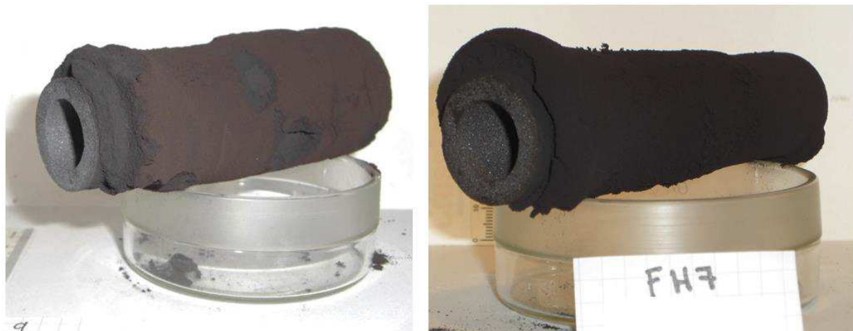
Figure 51 : Etat de la chandelle filtrante après les séries \mu -SFS (gauche) et \mu -BW (droite). Notons que les fragments de charbon détachés de la chandelle lors de son extraction du carter du filtre ont été récupérés et pesés. La masse de ces fragments a été additionnée à la masse du charbon totale récupérée sur le filtre ( m_{\text{char-FHT}} ).
