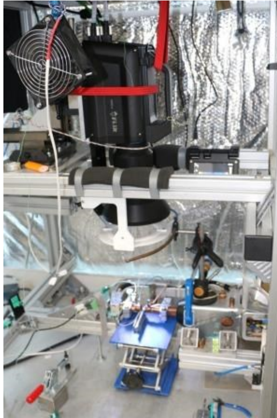
Figure 3.11 – Installation de la caméra IR au-dessus de la pince de soudage.
