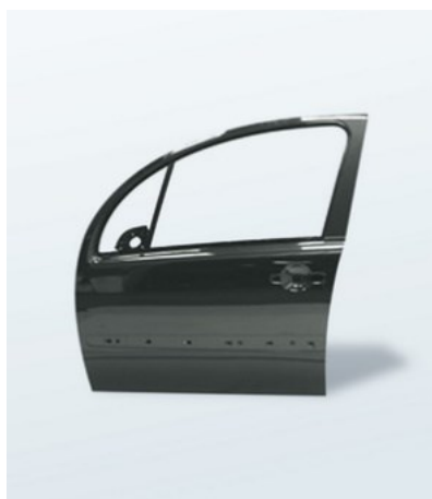
Figure 2.2 - Portière en acier « Bake Hardening ».
