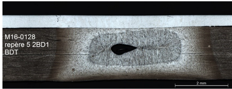
Figure 2 - Coupe macrographique de soudure entre une tôle fine d'acier doux et une tôle d'acier à très haute résistance (étude interne ArcelorMittal).
