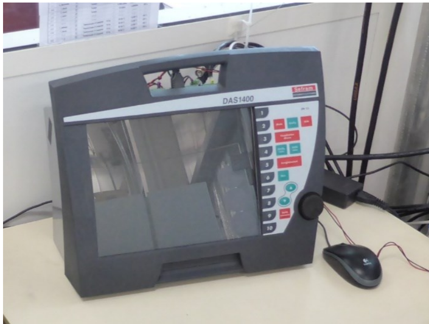
Figure 3.6 – Centrale d'enregistrement numérique.
