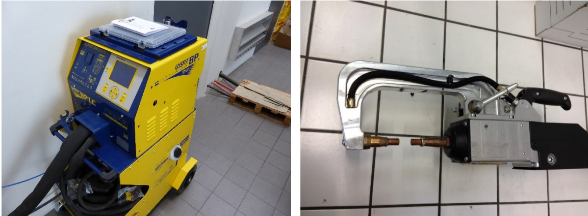
Figure 3.1 – GYSPOT BP.LC : (gauche) chariot et (droite) pince de soudage, type C 95 mm.
