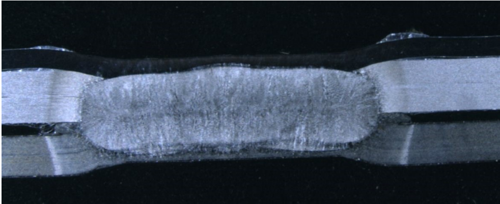
Figure 10.14 – Coupe macrographique d'un point réalisé avec les électrodes G0-20-22-50-8 usées.
