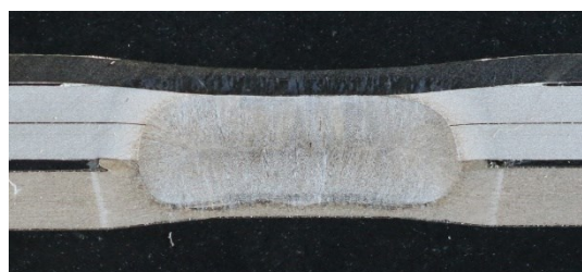
Figure 8.25 - Coupes macrographiques de points interrompus et cartographie numérique de température.
