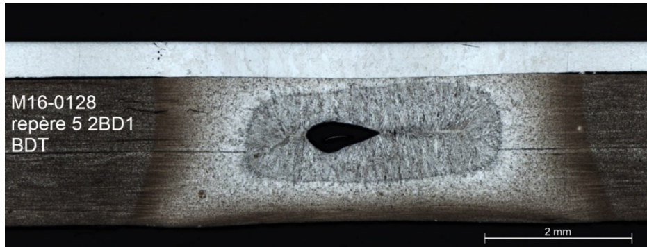
Figure 1.7 - Coupe macrographique d'un assemblage dissymétrique de deux tôles (AM54 0,57 mm / DP600 2 mm) (étude interne ArcelorMittal).
