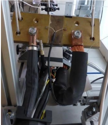
Figure 3.2 - Shunt électrique : (gauche) installation (droite) simulation numérique des échauffements.
