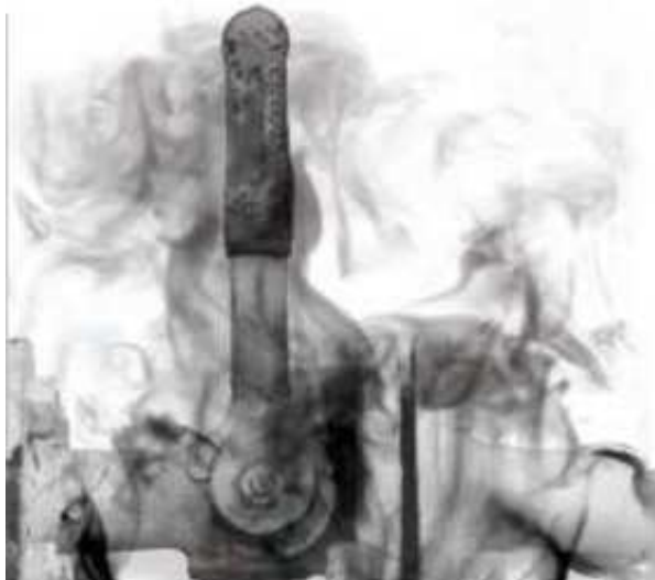
FIGURE 1 – Exemple de fuites de gaz COV détectées par caméra infrarouge (issue de http://www.lspp.fr ).
