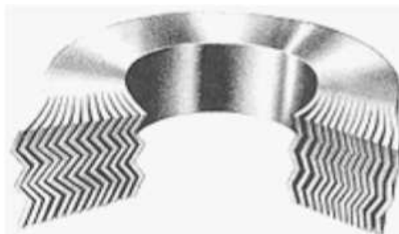
FIGURE 1.13 – Structure interne d'un joint en graphite expansé matricé Roe et Torrance [2008b] .
