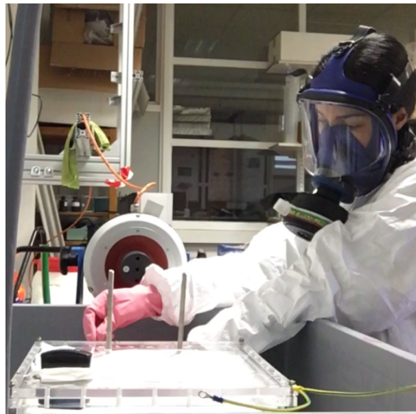
FIGURE 4.6 – Photo de la mise en place de l'expérience avec l'huile silicone 1 cSt qui a nécessité le port d'un équipement de sécurité.
