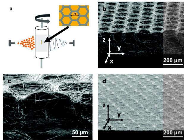
FIGURE 2.32 – (a) Schéma du montage de l'électrospinning, électrospraying simultanés (b) Structure 3D en forme de colonnes obtenue après 1h de dépôt pour  $D = 160\ \mu\text{m}$  (c) Structure 3D en forme de colonnes obtenue après 15 minutes de dépôt (d) Structure fibreuse obtenue dans les mêmes conditions que (b) mais sans électrospraying : aucune micro-structure 3D interne n'est obtenue ; d'après Wittmer et al. [43].
