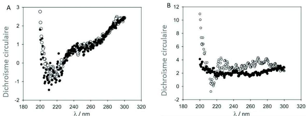
FIGURE 5.10 – A : Spectre DC de l'ALP dans le tampon ( $\circ$ ) and spectre DC de l'ALP au contact avec une solution de  $\text{NaIO}_4$  10 mM dans le même tampon ( $\bullet$ ). B : Spectre DC de films PEI-(ALP-AT)<sub>6</sub> ( $\circ$ ) et spectre DC de ces mêmes films après traitement avec une solution de  $\text{NaIO}_4$  10 mM pendant 5 minutes ( $\bullet$ ).
