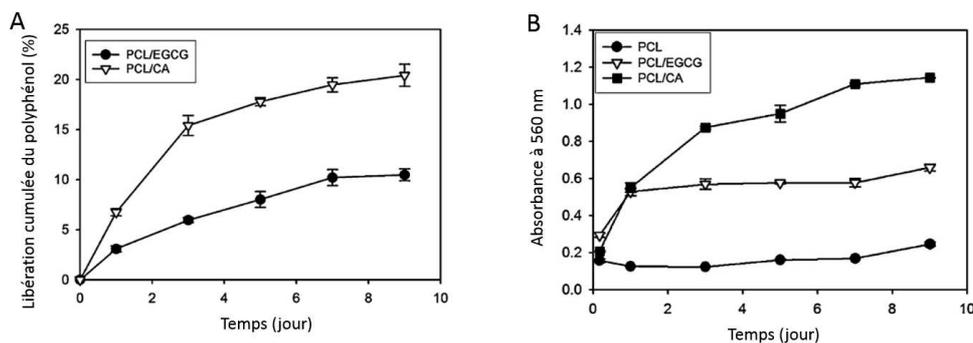
FIGURE 1.22 – A : libération de l'acide caféique (CA) et de l'EGCG au cours du temps quand les fibres sont plongées dans du tampon phosphate; B : Détection de peroxyde d'hydrogène  $H_2O_2$  généré dans le milieu de culture par les polyphénols d'après Kim et al. [103]
