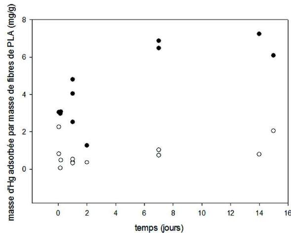
FIGURE 3.17 – Cinétique d'adsorption de l'Hb sur des fibres de PLA traitées (●) et non traitées (○) au plasma pour une solution d'Hb à 0,1 mg/mL.
