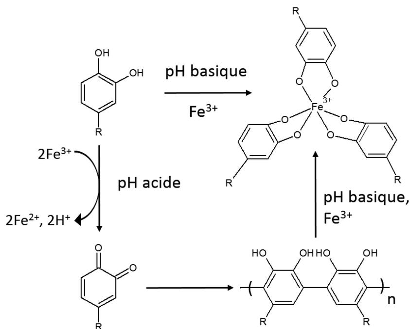
FIGURE 4.22 – Schéma des interactions des catéchols avec les ions  $\text{Fe}^{3+}$ .
