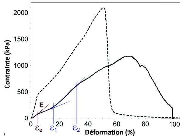
FIGURE 2.36 – Courbes caractéristiques d’un test de traction pour un scaffold de PLA électrospinné simplement (ligne en pointillés) et d’un scaffold de PLA structuré par électrospinning-électrospraying (ligne pleine) ; d’après Wittmer et al. [43].
