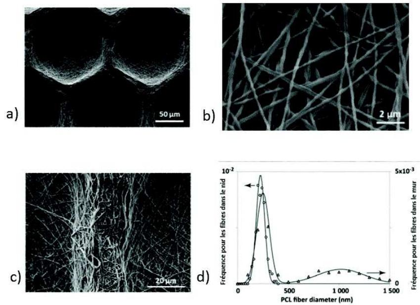
FIGURE 2.27 – Images MEB de a) fibres de PCL déposées sur un motif en nid d’abeille avec une taille de pore de  $160\ \mu\text{m}$  b) nanofibres de PCL à l’intérieur du nid c) nanofibres de PCL sur les murs du nid d) répartition des diamètres sur les murs et à l’intérieur des nids; d’après Nedjari et al. [41].
