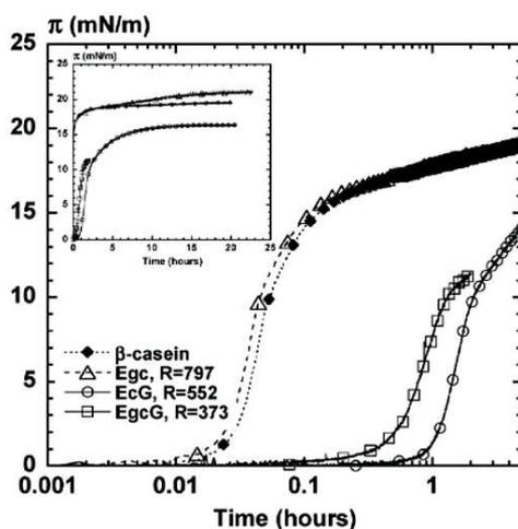
FIGURE 1.10 – Pression de surface  $\pi$  à l'interface air-eau pour une solution de caséine à 10 mg/mL seule ou en présence de EGC, ECG et EGCG. L'encart présente la cinétique complète ; d'après Aguié-Begin et al. [27].
