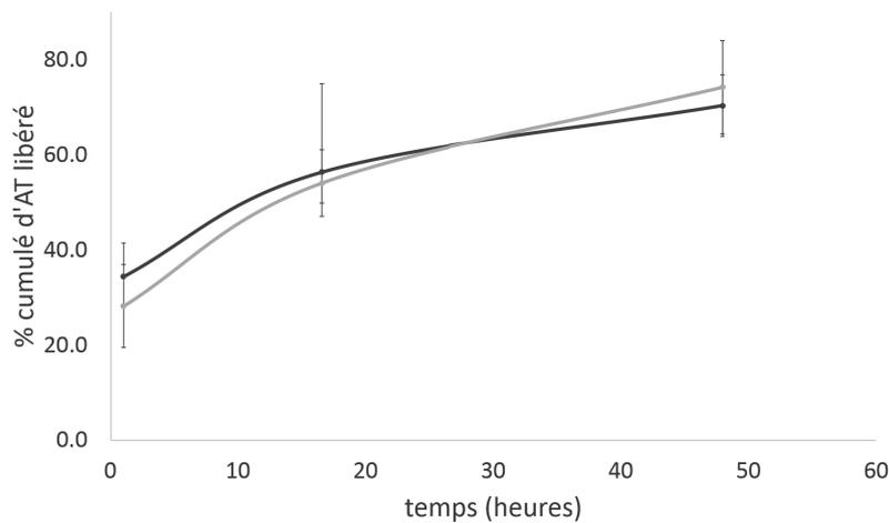
FIGURE 3.8 – AT libéré au cours du temps pour des matériaux PLA+10% d'AT électrospinnés pendant 10 minutes (—) et PLA+15% d'AT électrospinnés pendant 10 minutes (—)
