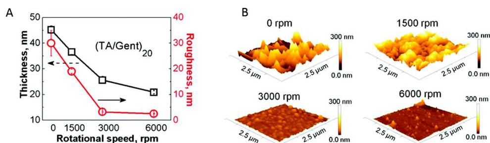
FIGURE 1.14 – A : Epaisseur et rugosité des films en fonction de la vitesse de rotation lors du spin coating. B : images AFM des films en fonction de la vitesse de rotation lors du spin coating. La vitesse à 0 rpm représente des films construits par trempage, d'après Zhuk et al. [46].
