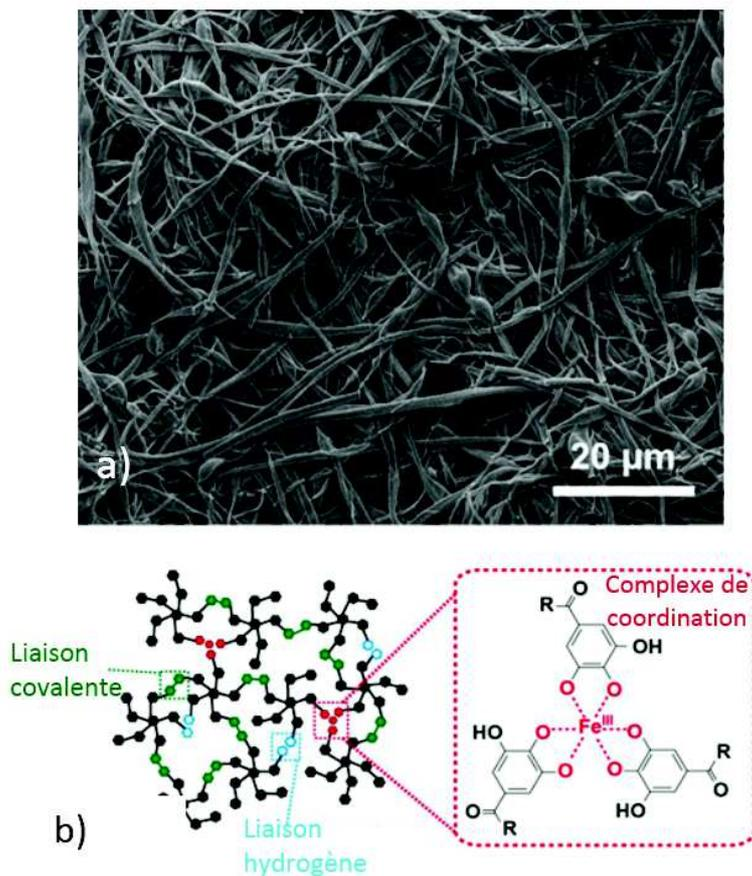
FIGURE 4.23 – a) Image MEB de matrice d'AT après réticulation avec une solution aqueuse à 40%mt en nitrate de fer pendant 10 secondes suivie d'une complexation à pH=8 pendant 6 heures. b) Schéma des interactions entre les molécules d'AT après réticulation avec une solution contenant des ions Fe<sup>3+</sup>
