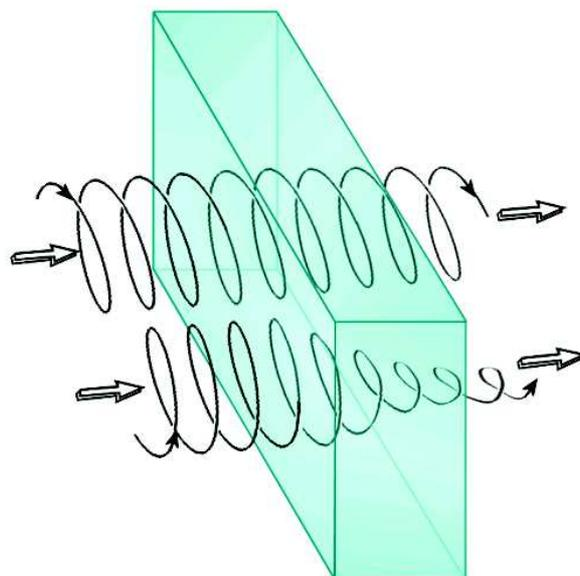
FIGURE 2.52 – Lorsqu’une lumière polarisée circulairement gauche et une lumière polarisée circulairement droite traversent un milieu optiquement actif, elles ne sont pas absorbées de la même manière.
