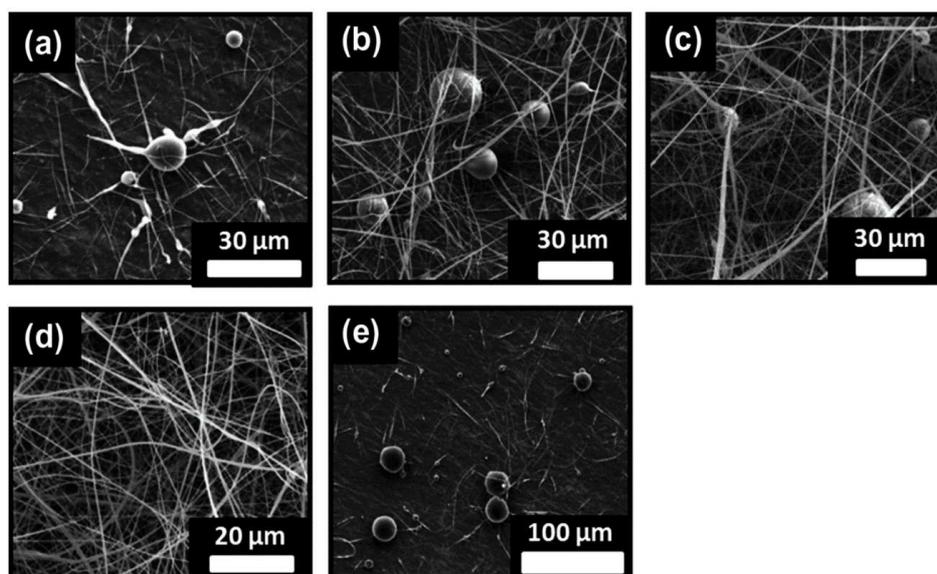
FIGURE 4.11 – Images MEB des fibres de  $\beta$ -CD dans une solution aqueuse avec 10% m/v de NaOH. Pour différentes concentrations en CD (a) 120% (m/v), (b) 130% (m/v), (c) 140% (m/v), (d) 150% (m/v) and (e) fibres avec des perles après ajout d'urée représentant 20% de la masse d'urée dans une solution à 150% (m/v) en  $\beta$ -CD, d'après Celebioglu et al.[7]
