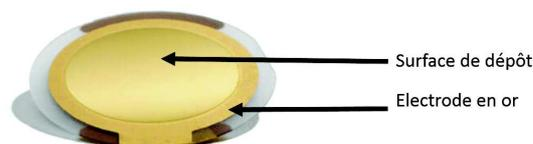
FIGURE 2.47 – Cristal de QCM du côté de la surface de dépôt
