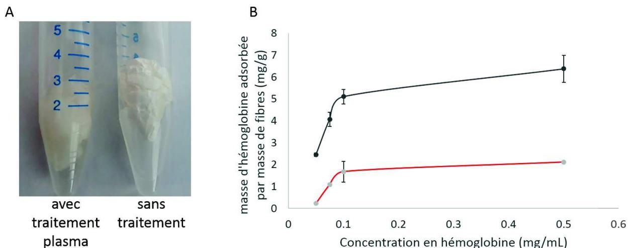
FIGURE 3.16 – A : Photo des fibres immergées dans une solution d'Hb. Pour le cas des fibres traitées au plasma, le matériau est tout de suite imprégnée de solution tandis que pour les fibres non traitées, le matériau reste à la surface ne gonfle pas du tout. B : masse d'Hb adsorbée par masse de fibres (mg/g) en fonction de la concentration en Hb après une immersion pendant 4 heures des fibres de PLA non traitées au plasma (—) et traitées au plasma (—).
