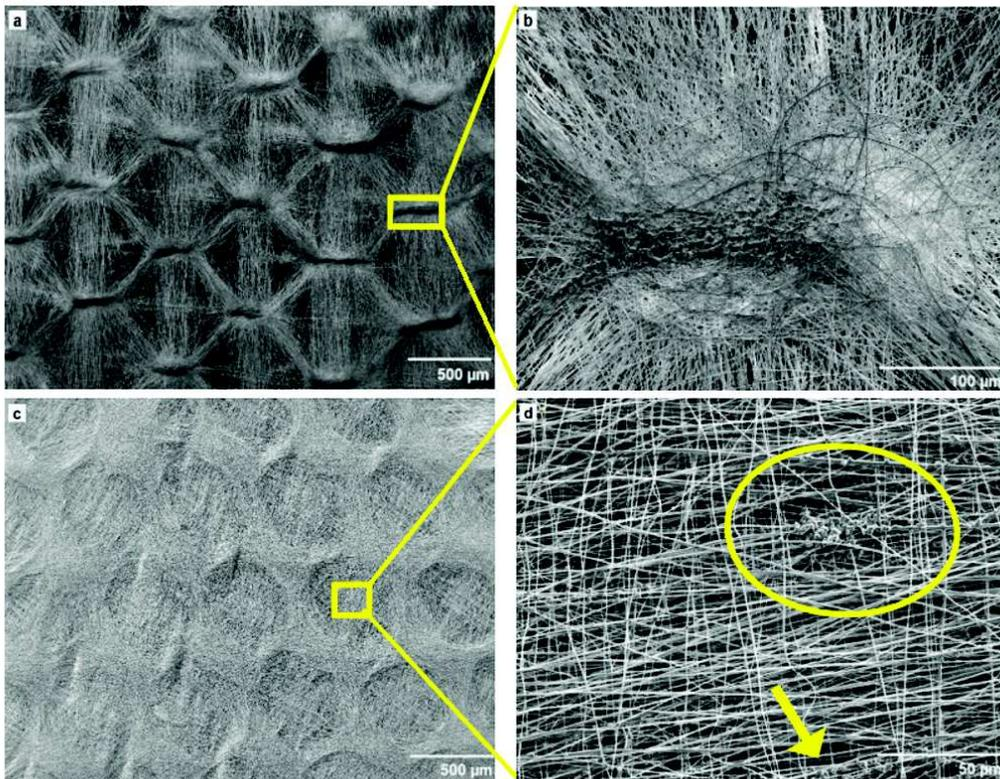
FIGURE 3.23 – Images MEB de matrices structurées en multicouches avec un ratio 1/1 (a et b) et un ratio 1/9 (c et d). La flèche et le cercle indique des particules sur les fibres.
