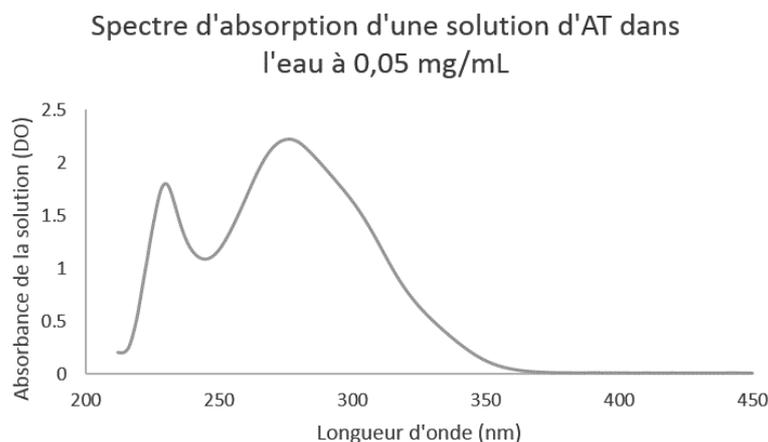
FIGURE 2.45 – Spectre d'absorption d'une solution d'AT dans l'eau à 0,05 mg/mL. Le spectre de l'AT présente deux maxima d'absorption un à 230 nm et un à 277 nm
