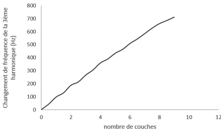
FIGURE 5.12 – Changement de fréquence pour la 3<sup>me</sup> harmonique après chaque étape de rinçage suivant le dépôt de PEI, de LYS ou d'AT en fonction du nombre de paires de couches.
