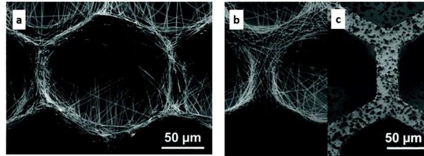
FIGURE 2.33 – (a) Image MEB obtenue après 3 minutes d'électrospinning-électrospraying sur un collecteur  $D = 160\mu\text{m}$  (b) Image MEB obtenue après 3 minutes d'électrospinning seul (c) Image MEB obtenue après 3 minutes d'électrospraying seul ; d'après Wittmer et al. [43].
