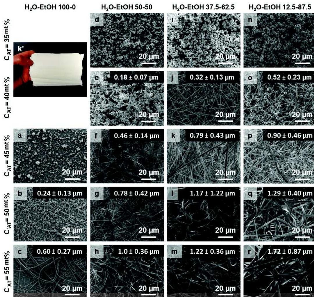
FIGURE 4.12 – Images MEB de fibres d'AT obtenues dans des mélanges eau-EtOH(100-0%ms ; 50-50%ms ; 37,5-62,5%ms ; 12,5-87,5%ms) à des concentrations en AT de 35%, 40%, 45%, 50% et 55% dans les mélanges et les diamètres moyens associés. La photo k' montre le matériau électrospinné qui a été obtenu à partir des conditions de l'image k. Le matériau est facilement manipulable.
