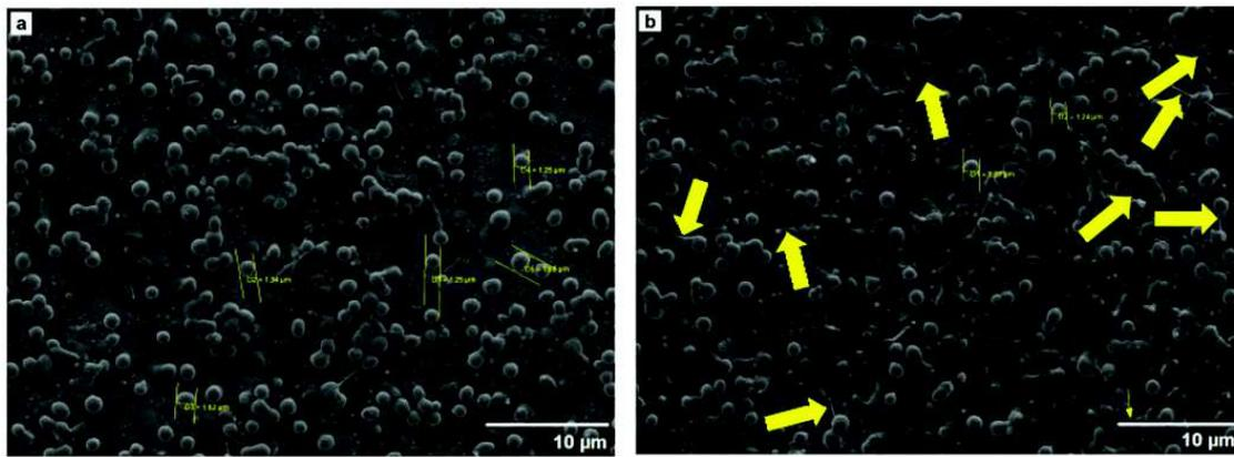
FIGURE 3.20 – Images MEB de particules obtenues à partir d'une solution A : à 10%mt de PCL et 30% d'AT B : à 10%mt de PCL et 40% d'AT, des fibrilles apparaissent (flèches jaunes).
