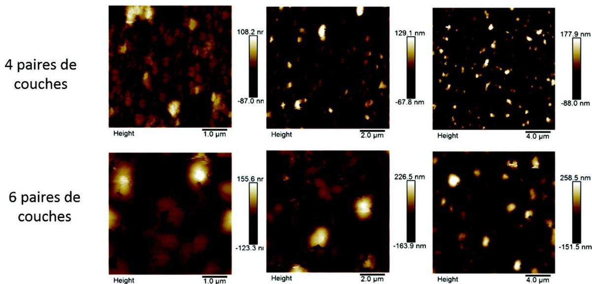
FIGURE 5.3 – Topographie de la surface de films PEI-(ALP-AT) $_n$  pour  $n = 4$  (première ligne) et  $n=6$  (seconde ligne) en AFM en mode contact après séchage. La taille des images vaut  $5 \mu\text{m} \times 5 \mu\text{m}$  ( $1^{\text{re}}$  colonne),  $10 \mu\text{m} \times 10 \mu\text{m}$  ( $2^{\text{me}}$  colonne),  $20 \mu\text{m} \times 20 \mu\text{m}$  ( $3^{\text{me}}$  colonne).
