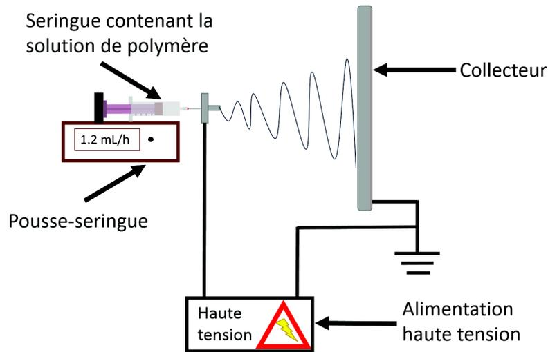
FIGURE 2.2 – Schéma du montage d'une cabine d'électrospinning
