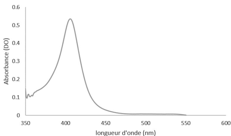
FIGURE 2.46 – Spectre d'une solution d'hémoglobine dans un tampon Tris 50 mM NaCl 100 mM à pH=7,4 pour une concentration de 0,1 mg/mL. Le spectre présente un pic à 406 nm.
