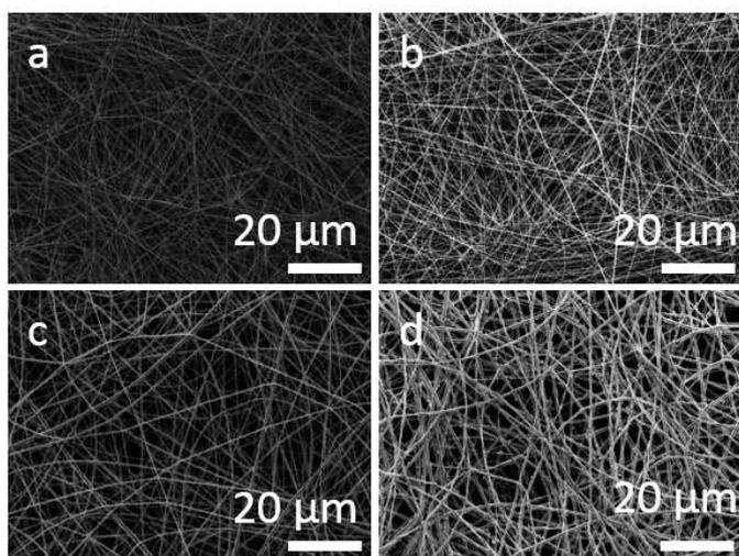
FIGURE 3.4 – Images MEB de fibres de PLA+AT a) sans AT b) avec 5% d'AT c) avec 10% d'AT et d) avec 20% d'AT
