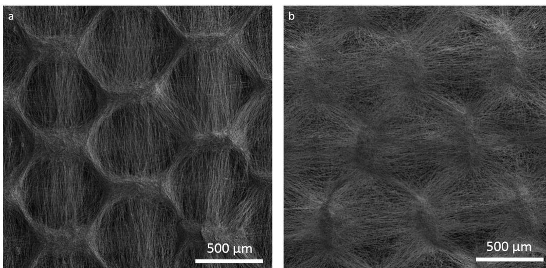
FIGURE 3.27 – Images MEB de matrices structurées à l'aide de 3 aiguilles d'électrospraying et d'une aiguille d'électrospinning de fibres de PLA en rotation continue avec a : des particules PCL-AT ; b : des particules de PCL seul sans ajout d'AT.
