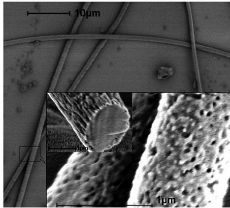
FIGURE 2.8 – Images de microscopie électronique à balayage de fibres électrospinnées de poly-méthylsilsesquioxane dans un mélange méthanol-propanol pour un ratio en volume 2/3, d’après Luo et al. [22].
