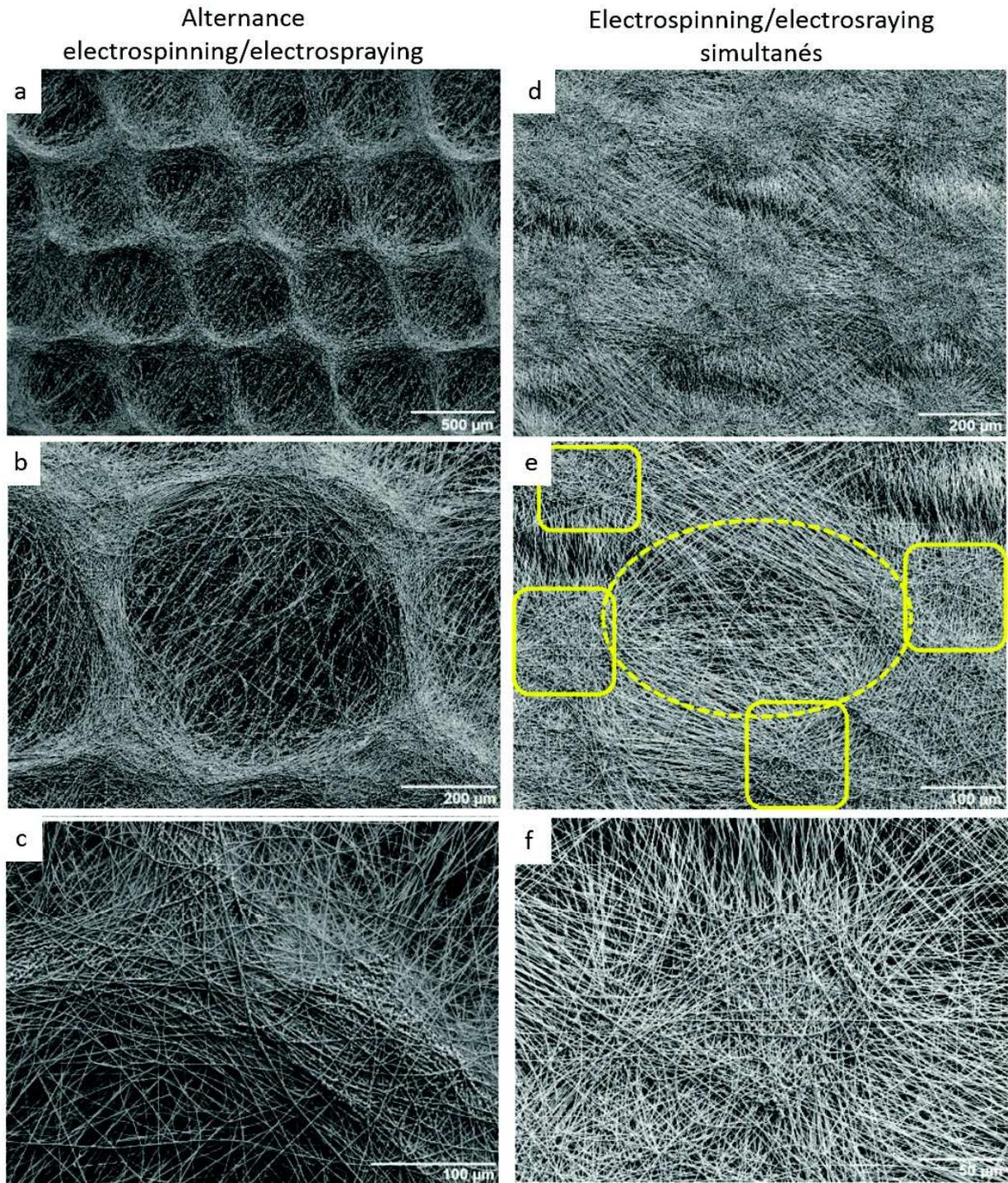
FIGURE 3.24 – Images MEB de matrices structurées en multicouches avec un ratio 1/3 en alternant l'électrospinning de PLA et l'électrospraying de particules de PCL-AT (a-c) et en réalisant en continu l'électrospinning et l'électrospraying (d-f)
