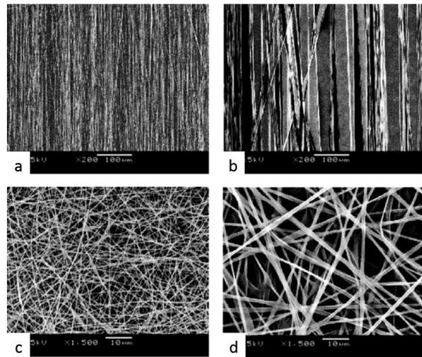
FIGURE 2.19 – Imagerie de microscopie électronique à balayage de fibres de PLA a) nanofibres alignées b) microfibres alignées c) nanofibres déposées aléatoirement d) microfibres déposées aléatoirement ; d’après Yang et al. [34].
