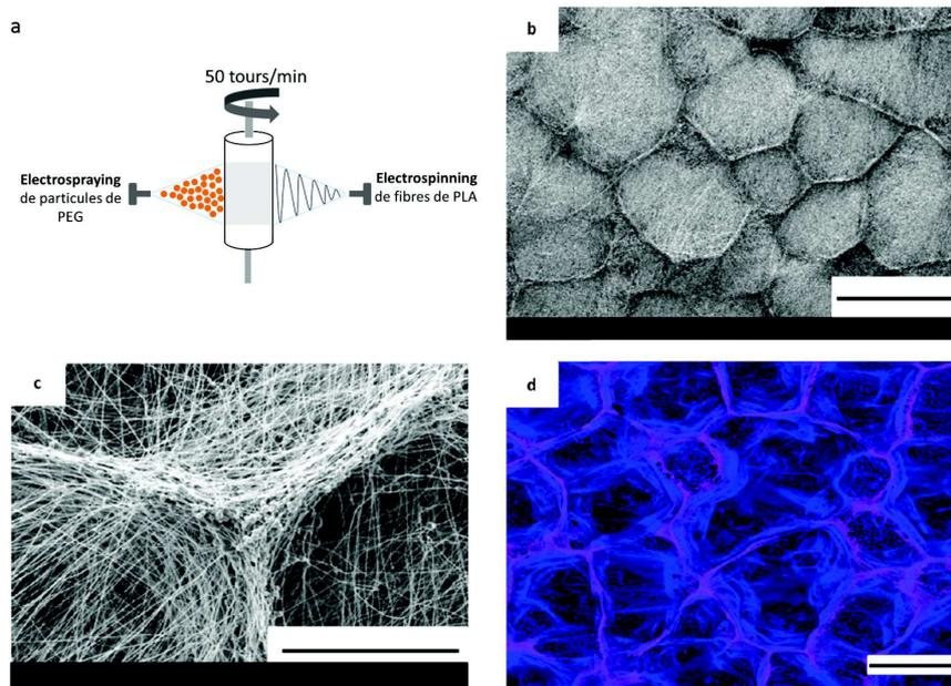
FIGURE 2.30 – (a) schéma du co-électrospinning-électrospraying (b) Image MEB de la structure composite en forme de nid d'abeille obtenue après 60 minutes (échelle=1 mm) (c) Image MEB d'un domaine élémentaire de nid d'abeille (échelle=50  $\mu\text{m}$ ) (d) Image de microscopie confocale avec les nanofibres de PLA marquées en bleu et les microparticules de PEG marquées en rose après 60 minutes de dépôt (échelle=500  $\mu\text{m}$ ), d'après Lavielle et al. [42].
