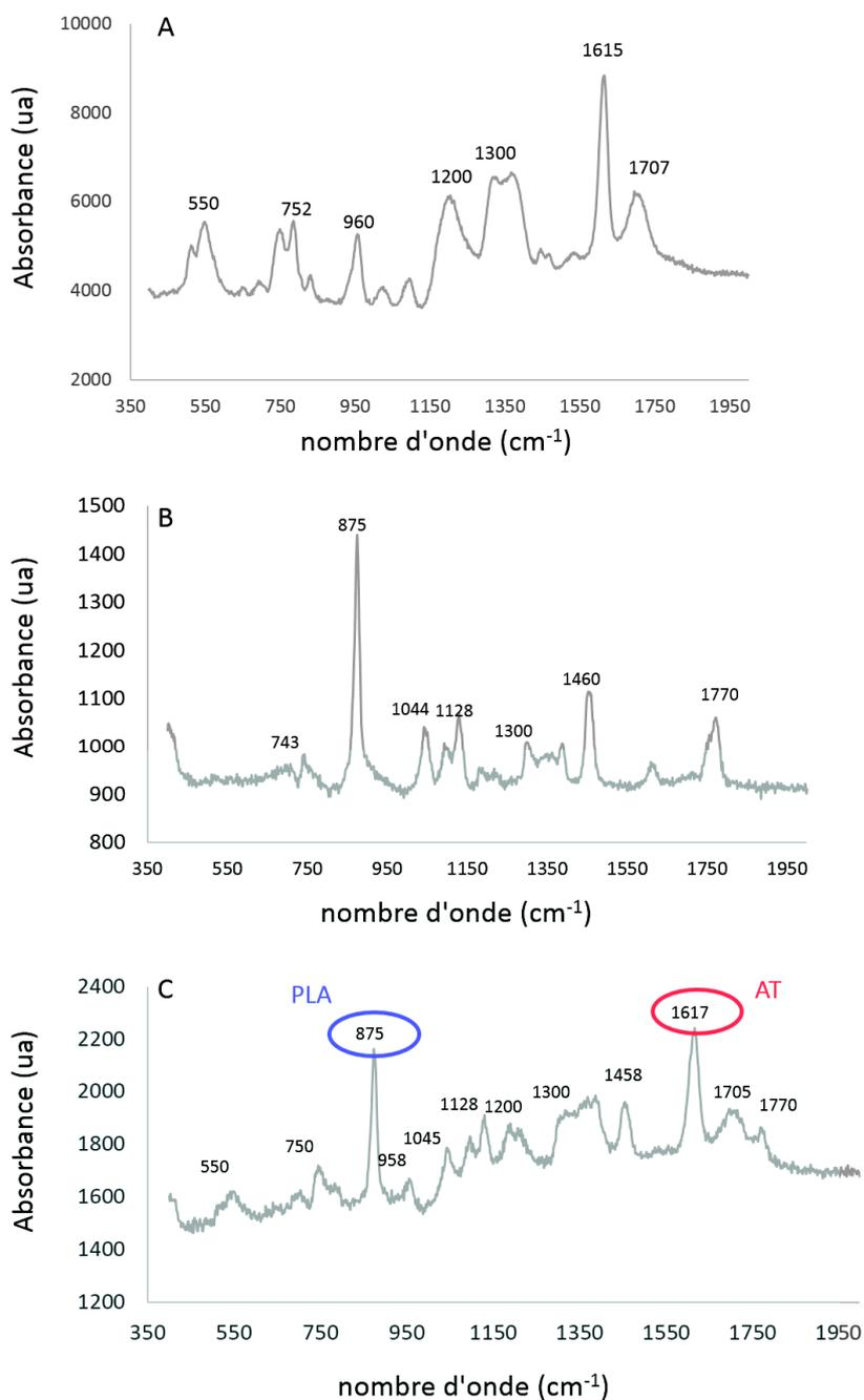
FIGURE 3.7 – A : spectre Raman de l'acide tannique B : spectre Raman de fibres de PLA seul C : spectre Raman de fibres PLA+20% d'AT
