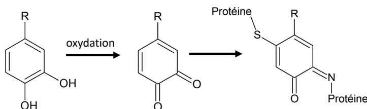
FIGURE 1.7 – Schéma représentant la formation de liaisons covalentes entre un polyphénol et des protéines à la suite d'une oxydation des fonctions hydroxyles en quinones, d'après Beart et al. [21].
