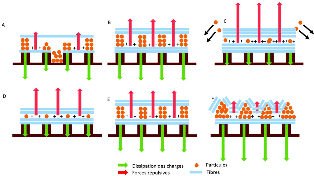
FIGURE 3.28 – Schéma de la structuration du matériau en 3 dimensions. Les schémas a, b et c représentent la structuration pour une même quantité de particules déposées et une quantité de fibres déposées différentes tandis que les schémas d, e et f représentent la structuration pour une même quantité de fibres déposées et une quantité de particules déposées différentes. Les flèches en noir représentent l'éjection des particules hors du collecteur dû à un trop fort champ électrostatique répulsif.
