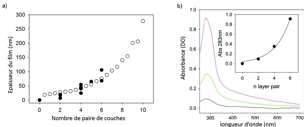
FIGURE 5.5 – a) Epaisseur des films mesuré en ellipsométrie (●) et à partir des données de la QCM (○) b) Spectres UV-vis de films PEI-(ALP-AT)<sub>n</sub> pour n=2 en noir, n=4 en vert et n=6 en rose.
