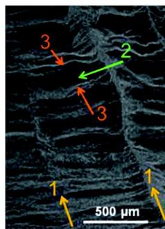
FIGURE 2.25 – Image MEB d'une coupe du scaffold de PCL épais montrant les colonnes et les mesopores des couches stratifiées, d'après Nedjari et al. d'après Ahirwal et al. [39].
