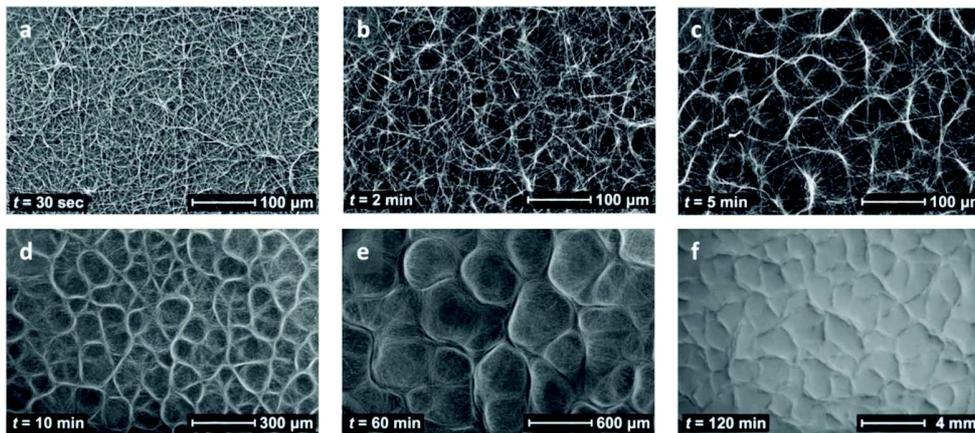
FIGURE 2.23 – Images MEB d'électrospinning de PCL à 13% mt obtenu après un temps de (a) 30 secondes (b) 2 minutes (c) 5 minutes (d) 10 minutes (e) 60 minutes (f) 120 minutes; d'après Ahirwal et al. [39].
