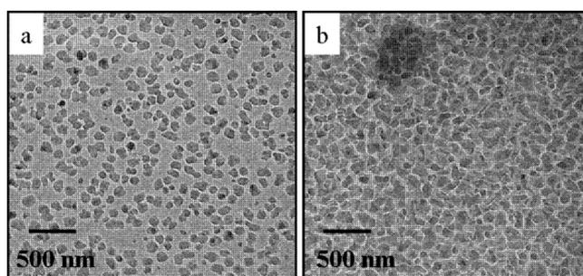
FIGURE 4.6 – Images de Cryo-MET d'une solution de tensio-actif géminé dans un mélange eau :methanol (1 :1 en volume) (a) 10 %mt, micelles globulaires indépendantes, (b) 12 %mt micelles se chevauchant, d'après Cashion et al.[4]
