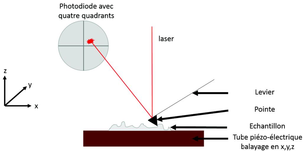
FIGURE 2.51 – Schéma du principe de fonctionnement de l'AFM. La surface de l'échantillon est balayée grâce à la pointe du cantilever. Leurs interactions entraînent la déflexion du levier. Cette déflexion est mesurée grâce à un faisceau laser dévié par l'extrémité du levier sur une photodiode
