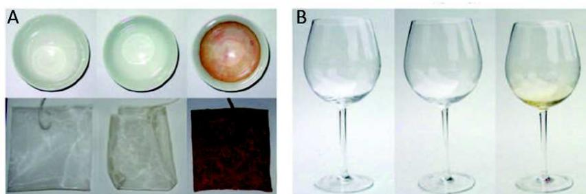
FIGURE 1.11 – Photos d'une tasse à thé et d'un sachet de thé (A) et d'un verre à vin (B). A gauche : avant contact ; au milieu : après contact avec du thé (A) et du vin (B) et rinçage à l'eau ; à droite, mise en évidence du dépôt de polyphénols à l'aide d'une solution aqueuse de  $\text{AgNO}_3$  ; d'après Sileika et al. [36].
