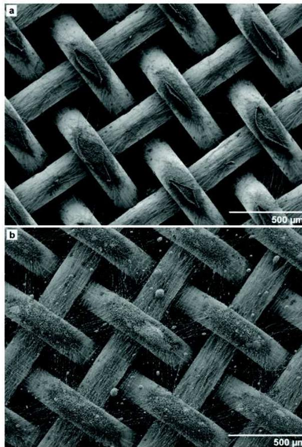
FIGURE 3.19 – Fibres de PLA obtenues à partir d’une solution à 10%mt avec A : des particules de PCL obtenues à partir d’une solution à 10%mt et B : des particules de PCL obtenues à partir d’une solution à 30%mt
