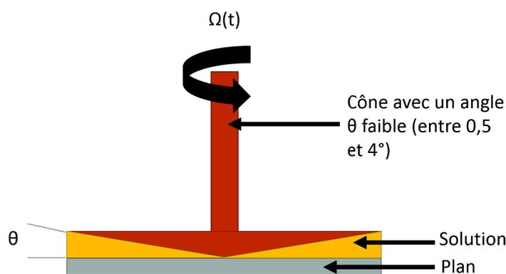
FIGURE 2.43 – Schéma d'une géométrie cône-plan
