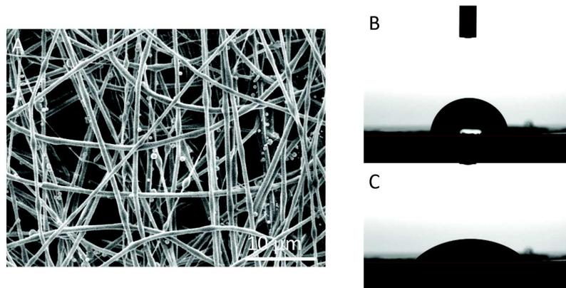
FIGURE 3.14 – A : Image MEB de fibres PLA+20% d'AT présentant des petites particules d'AT. B et C : Etalement d'une goutte d'eau sur les mêmes fibres, la photo C a été prise 20 secondes après la photo B.
