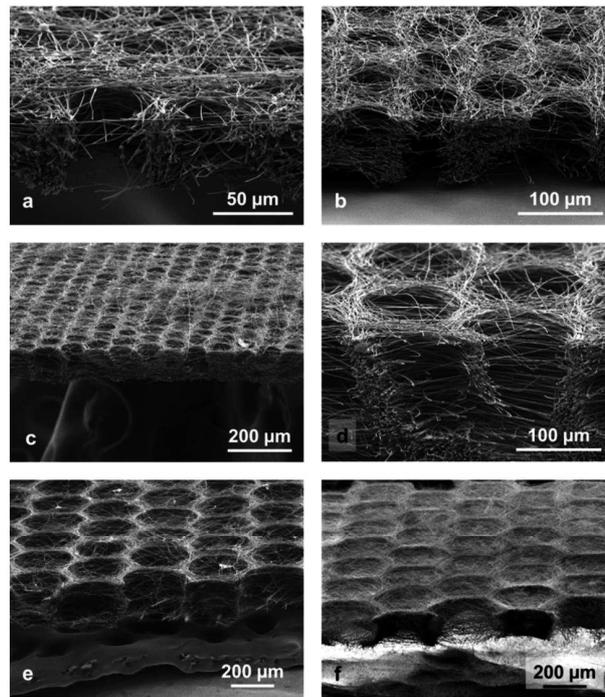
FIGURE 2.35 – Images MEB de différentes structures 3D pour des tailles de motif  $D$  différentes montrant leur section ainsi que la surface qui était en contact avec le collecteur (a)  $D = 40 \mu\text{m}$  (b et c)  $D = 80 \mu\text{m}$  (d)  $D = 160 \mu\text{m}$  (e et f)  $D = 360 \mu\text{m}$ , d'après Wittmer et al. [43].
