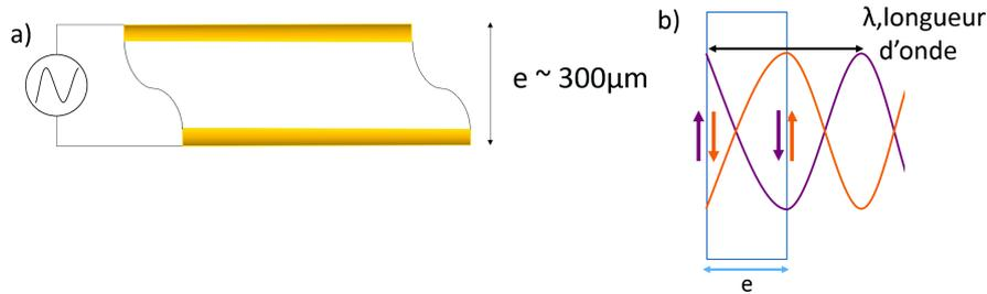
FIGURE 2.48 – a) Représentation schématique du cristal de quartz excité électriquement : les deux faces bougent dans des sens opposés b) Les deux faces du cristal oscillent dans des sens opposés de manière alternative. La longueur d'onde de cisaillement vaut  $2e$ .
