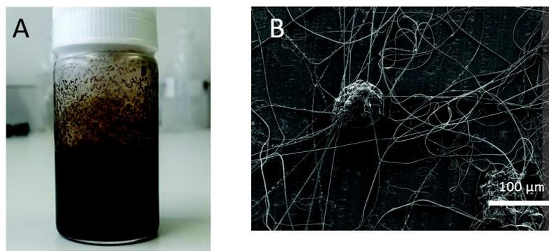
FIGURE 3.11 – A : Photo d'une solutions de PLA+10% d'AT avec du  $\text{NaIO}_4$  pour avoir un rapport molaire  $\text{NaIO}_4/\text{AT}$  de 10. B : Image MEB de fibres électrospinnées obtenues à partir de la solution de PLA+10% d'AT contenant du  $\text{NaIO}_4$  avec un rapport molaire  $\text{NaIO}_4/\text{AT}$  de 10. Il n'est plus possible d'obtenir des fibres homogènes
