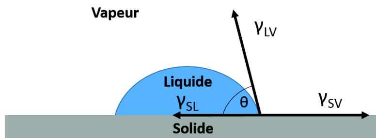
FIGURE 2.39 – Schéma d'une goutte à l'équilibre sur une surface
