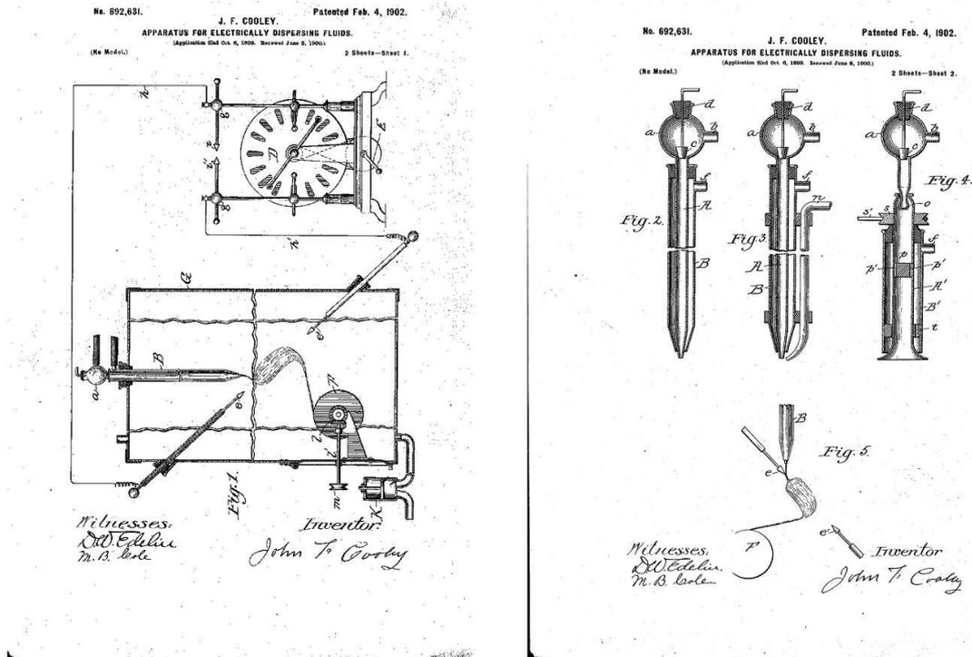
FIGURE 2.1 – Extrait du brevet de J.F. Cooley pour un dispositif de dispersion d'un fluide sous l'action d'un champ électrostatique [6].
