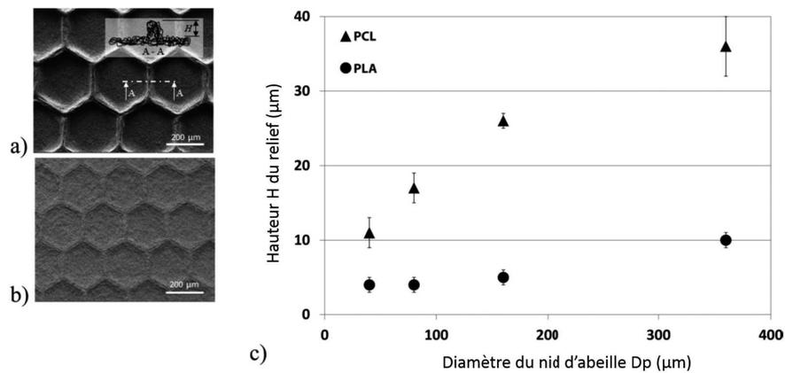
FIGURE 2.28 – a) Image MEB du scaffold de PCL obtenu avec  $D_p=360\ \mu\text{m}$  b) Image MEB du scaffold de PLA obtenu avec  $D_p=360\ \mu\text{m}$  c) Taille de la hauteur du relief en fonction de la taille du motif; d’après Nedjari et al. [41].
