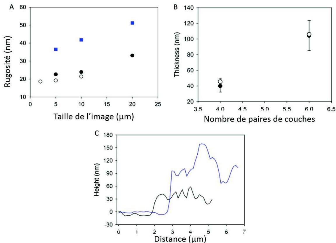
FIGURE 5.4 – A : Evolution de la rugosité en fonction de la taille de l'image pour  $n=4$  pour deux films indépendants ( $\bullet$ ) et ( $\circ$ ) et pour un film avec  $n=6$  ( $\blacksquare$ ) B : comparaison de l'épaisseur des films déterminés par la mesure de la hauteur du profil déterminée en AFM ( $\bullet$ ) et l'épaisseur obtenue en ellipsométrie ( $\circ$ ). C : Lignes des profils obtenus sur des films rayés à l'aide d'une aiguille avec  $n=4$  (en noir) et  $n=6$  (en bleu)
