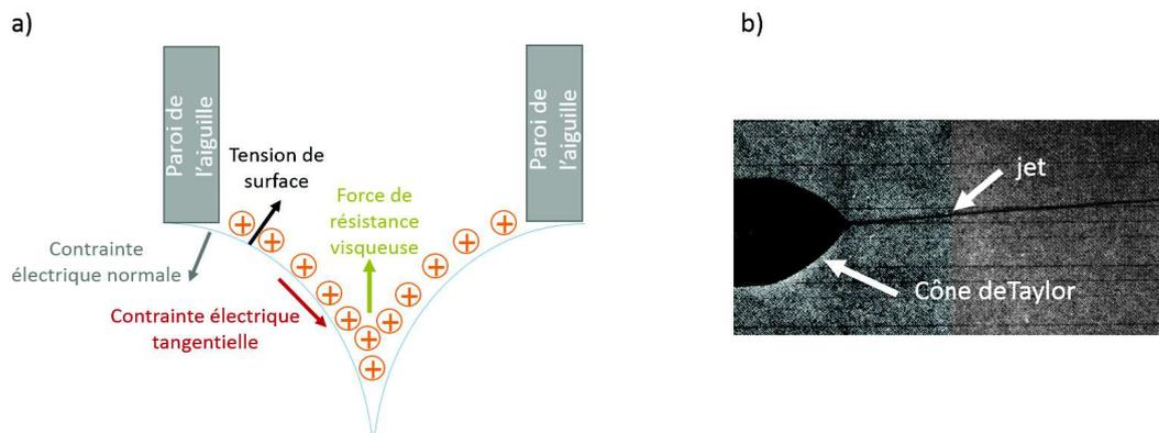
FIGURE 2.3 – a) Schéma des forces à la surface de la solution de polymère b) Photographie d'un cône de Taylor et d'un jet pour une solution de glycérine
