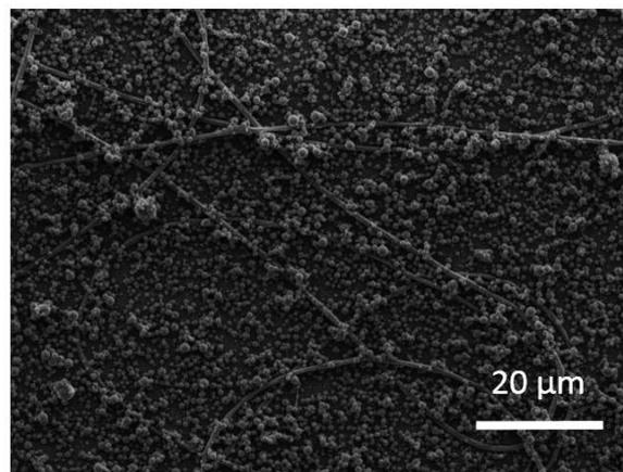
FIGURE 3.6 – Image MEB d'une solution de PLA + 30% d'AT électrospinnée. Un mélange de fibres et de particules est obtenu. L'AT et le PLA ne forme plus un mélange homogène pour une concentration en AT au delà de 20% d'AT.
