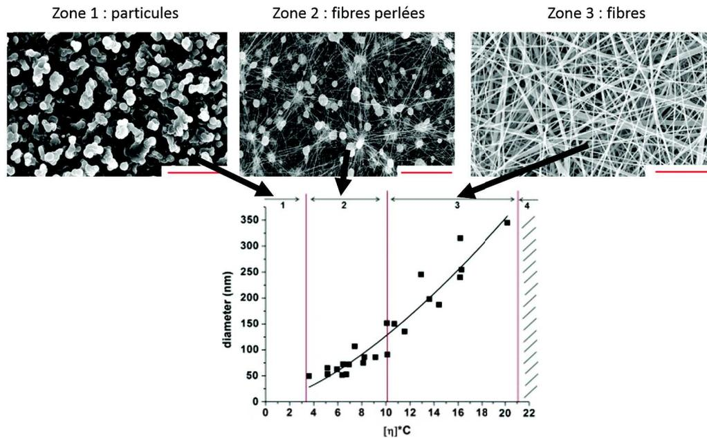
FIGURE 2.5 – Les trois zones de morphologie du PCL en fonction de  $[\eta]C$ . Zone 1 : électrospray, seules des particules sont obtenues. Zone 2 : des fibres perlées sont obtenues . Zone 3 : des fibres continues sont obtenues. Zone 4, au delà de  $[\eta]C$  qui vaut 21, la viscosité est trop forte et empêche l'électrospinning. La courbe en noir correspond au modèle qui relie le diamètre attendu des fibres en fonction du paramètre  $[\eta]C$ , d'après Lavielle et al. [16].
