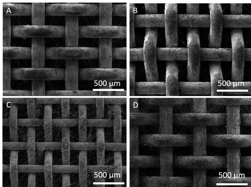
FIGURE 3.18 – Images MEB de fibres de PLA électrospinnées sur une grille pendant a : 15 secondes, b : 30 secondes, c : 45 secondes, d : 1minutes
