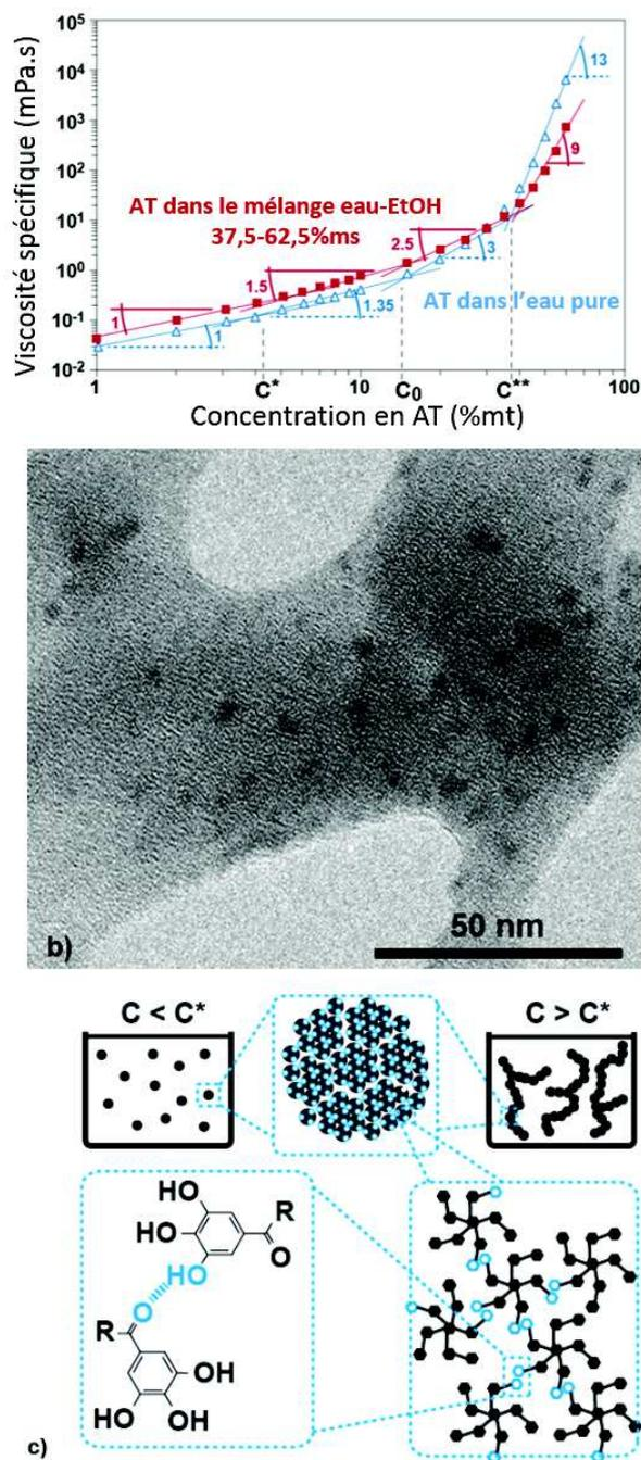
FIGURE 4.16 – a) Viscosité spécifique de solutions d'AT en fonction de la concentration à 22°C dans l'eau pure (triangle bleu) et dans le mélange eau-EtOH 37,5-62,5%mt (triangle rouge). b) Image de cryo-TEM obtenue pour une solution en AT dans un mélange eau-EtOH 37,5-62,5%mt et pour une  $C_{AT}$  de 2%mt qui montre dans les domaines noirs des agrégats d'AT
