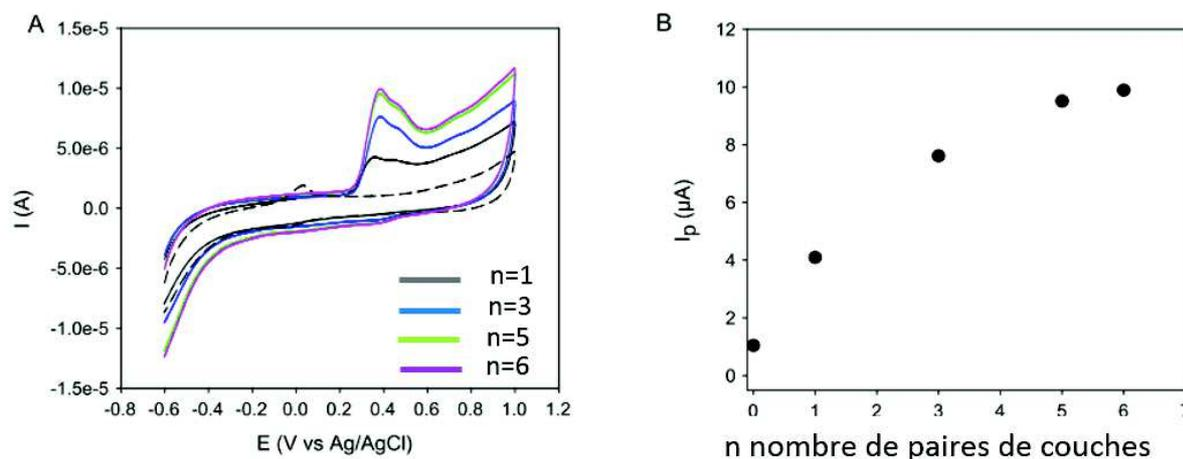
FIGURE 5.7 – A : Voltamogrammes cycliques (réalisé à  $100 \text{ mV}\cdot\text{s}^{-1}$ ) des films PEI-(ALP-AT) <sub>$n$</sub>  pour des nombres de paires de couches différents en absence de sonde rédox. La ligne en pointillés correspond à la courbe capacitive de l'électrode sans film déposé. B : Évolution de l'intensité du pic d'oxydation avec le nombre de paires de couches
