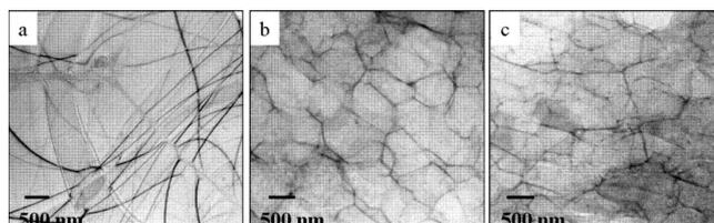
FIGURE 4.5 – Images de Cryo-MET d'une solution de tensio-actif géminé dans de l'eau (a) 1.0 %mt, micelles linéaires en forme de filament enchevêtrées (b) 2.4 %mt, micelles en forme de filaments ramifiés, (c) 4.1 %mt, réseau hautement ramifié de micelles enchevêtrées en forme de filaments, d'après Cashion et al.[4]
