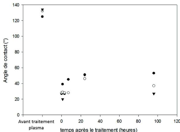
FIGURE 3.15 – Angles de contact de fibres de PLA électrospinnées pendant 10 minutes après traitement plasma en fonction du temps après le traitement. Les angles à -5 heures correspondent au temps avant traitement plasma.
