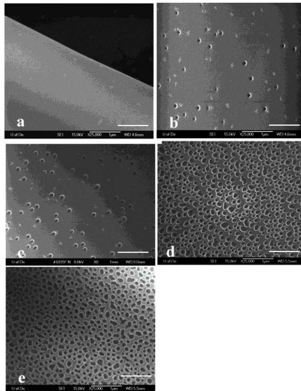
FIGURE 2.15 – Images de microscopie électronique à balayage de fibres de PS en fonction de l’humidité relative (a)  $<25\%$ , (b)  $31-38\%$ , (c)  $40-45\%$ , (d)  $50-59\%$ , (e)  $60-72\%$ . La barre d’échelle vaut  $1\mu\text{m}$ ; d’après Casper et al. [28].
