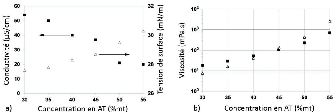
FIGURE 4.15 – a) Conductivité (■) et tension de surface ( $\Delta$ ) et b) viscosité en fonction de concentration en AT dans l'eau pure ( $\Delta$ ) et dans un mélange eau-EtOH 37,5-62,5%ms (■).
