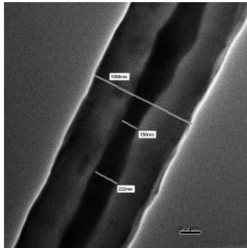
FIGURE 2.17 – Imagerie de microscopie électronique à transmission de fibres co-électrospinnées avec du PEO en coquille et du polythiophène en coeur ; d’après Sun et al. [32].
