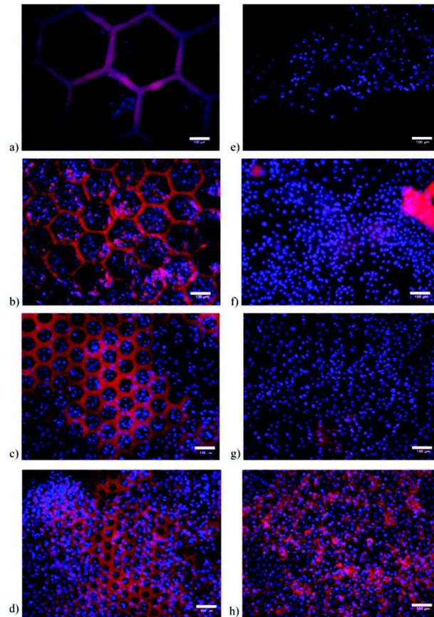
FIGURE 2.29 – Images de microscopie à fluorescence d’ostéoblastes après 14 jours (a-d) scaffolds de PCL (e-h) scaffolds de PLA ; (a) et (e)  $D_p=360\mu\text{m}$ , (b) et (f)  $D_p=160\mu\text{m}$ , (c) et (g)  $D_p=80\mu\text{m}$ , (d) et (h)  $D_p=40\mu\text{m}$  ; d’après Nedjari et al. [41].
