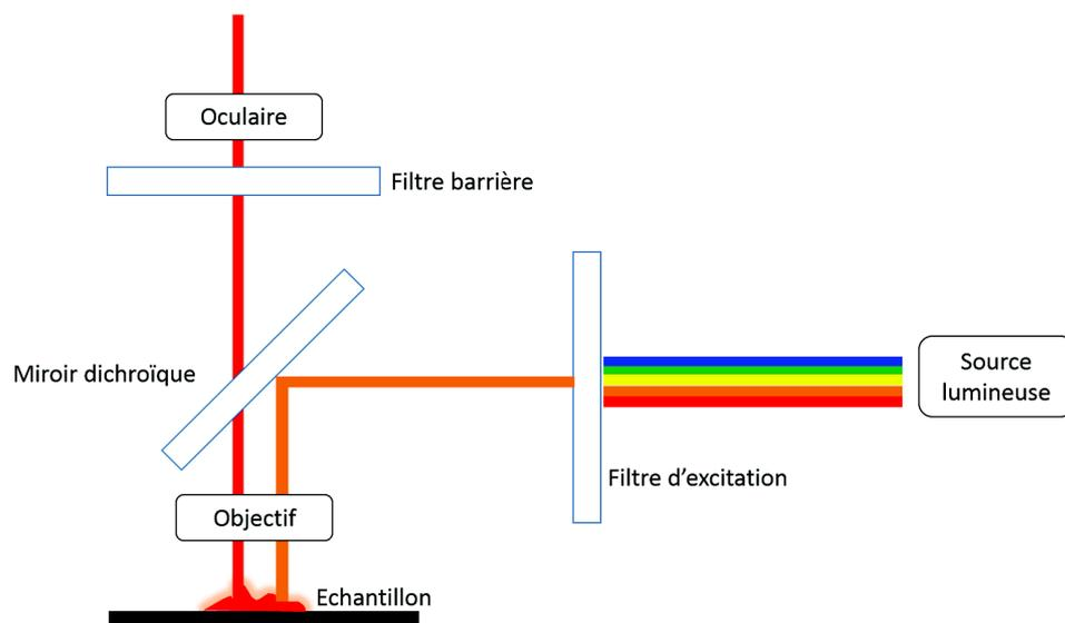
FIGURE 2.54 – Schéma d'un microscope à épifluorescence
