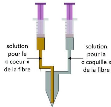
FIGURE 2.16 – Schéma du système utilisé pour l'électrospinning coaxial
