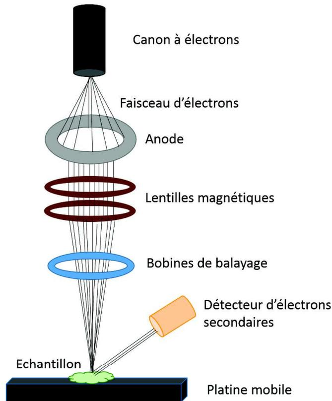
FIGURE 2.37 – Représentation schématique d'un microscope électronique à balayage. Le faisceau électronique est produit par un canon à électrons entre une cathode et une anode. Le faisceau d'électrons est ensuite focalisé grâce à des lentilles magnétiques. Le faisceau interagit ensuite avec l'échantillon produisant des électrons secondaires qui sont détectés par un détecteur d'électrons secondaires
