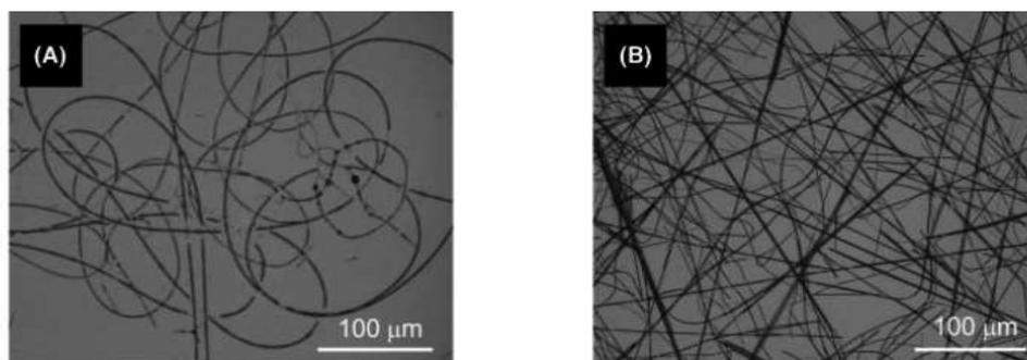
FIGURE 4.8 – A) Image de microscope optique de fibres électrospinnées de Phe-Phe pour une concentration de 17,5%mt B) Image de microscopie optique de fibres auto-assemblées pour une concentration à 0,08%mt (2,9mM) dans un mélange HFIP/eau, d'après Singh et al.[5]
