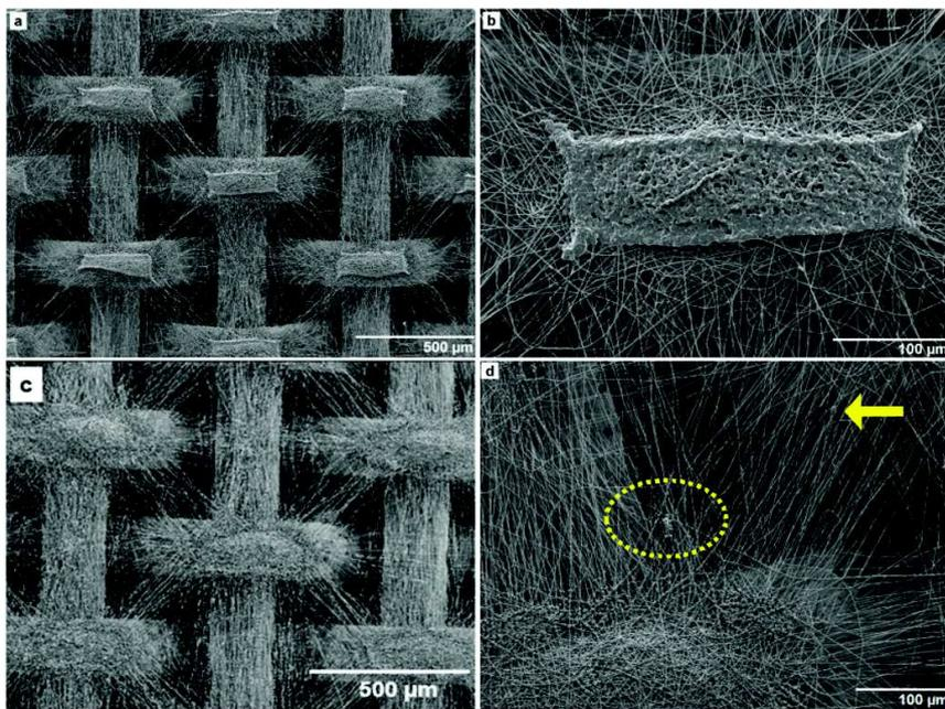
FIGURE 3.21 – A et B : Images MEB de fibres de PLA et de particules PCL-AT obtenues à partir de solution de 10%mt de PCL et 30% d'AT. C et D : Images MEB de fibres de PLA et de particules PCL-AT obtenues à partir de solution de 10%mt de PCL et 40% d'AT. La flèche et le cercle indiquent les rares défauts de positionnement.
