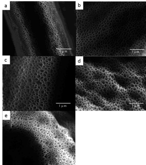
FIGURE 2.14 – Images de microscopie électronique à balayage de fibres de PS en fonction du débit (a)  $0.004 \text{ mL}\cdot\text{min}^{-1}$  (5 kV); (b)  $0.07 \text{ mL}\cdot\text{min}^{-1}$  (15 kV); (c)  $0.1 \text{ mL}\cdot\text{min}^{-1}$  (15 kV); (d)  $0.14 \text{ mL}\cdot\text{min}^{-1}$  (15 kV); (e)  $0.24 \text{ mL}\cdot\text{min}^{-1}$  (15 kV); d’après Megelski et al. [24].
