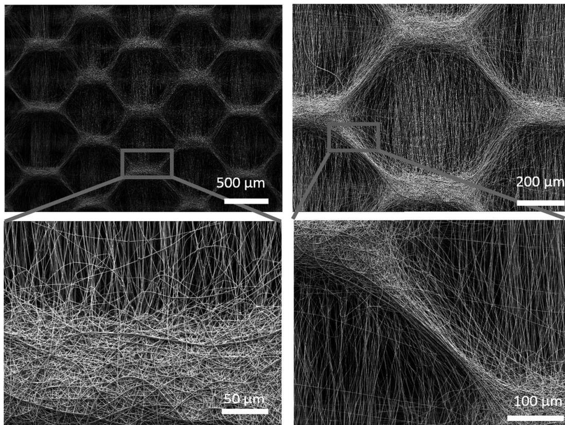
FIGURE 3.26 – Images MEB d’une matrice structurée à l’aide de 3 aiguilles d’électrospraying de PCL-AT et d’une aiguille d’électrospinning de PLA avec une rotation en continue du collecteur à 1 tour/minute.
