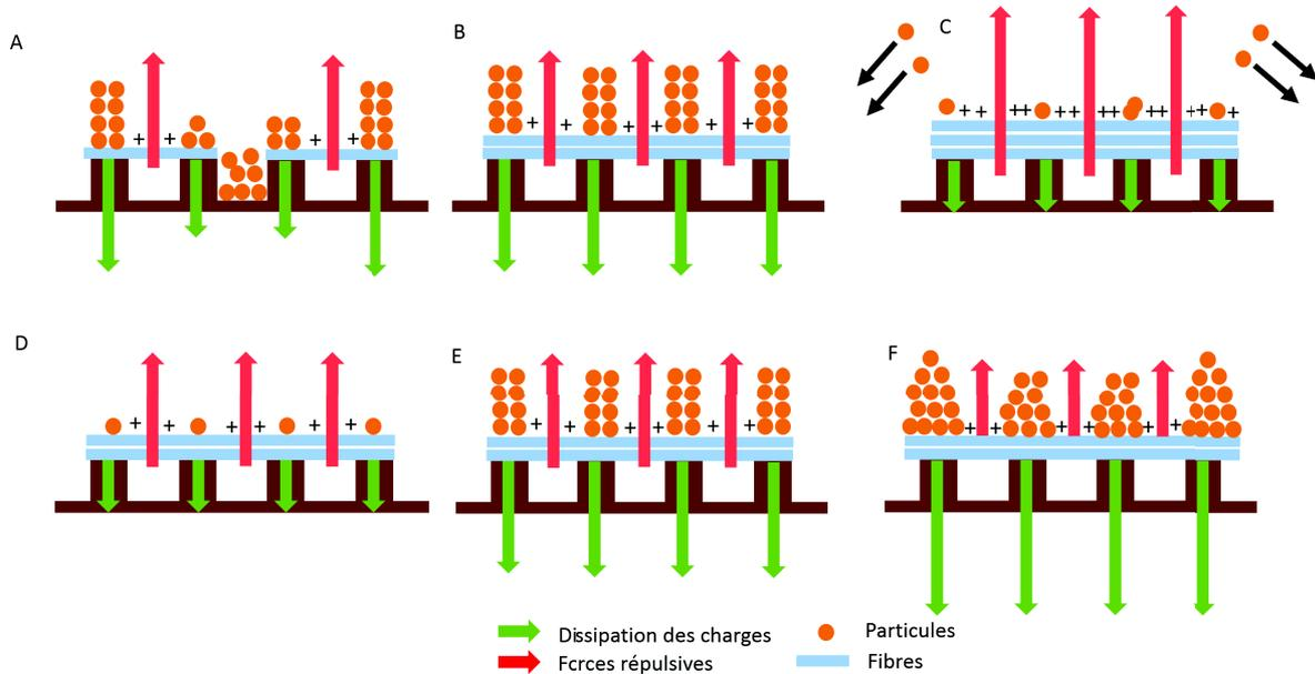
FIGURE 3.22 – Schéma de la structuration de la première couche. Les schémas a, b et c représentent la structuration pour une même quantité de particules déposées et une quantité de fibres déposées différentes tandis que les schémas d, e et f représentent la structuration pour une même quantité de fibres déposées et une quantité de particules déposées différentes. Les flèches en noir représentent l'éjection des particules hors du collecteur dû à un trop fort champ électrostatique répulsif.
