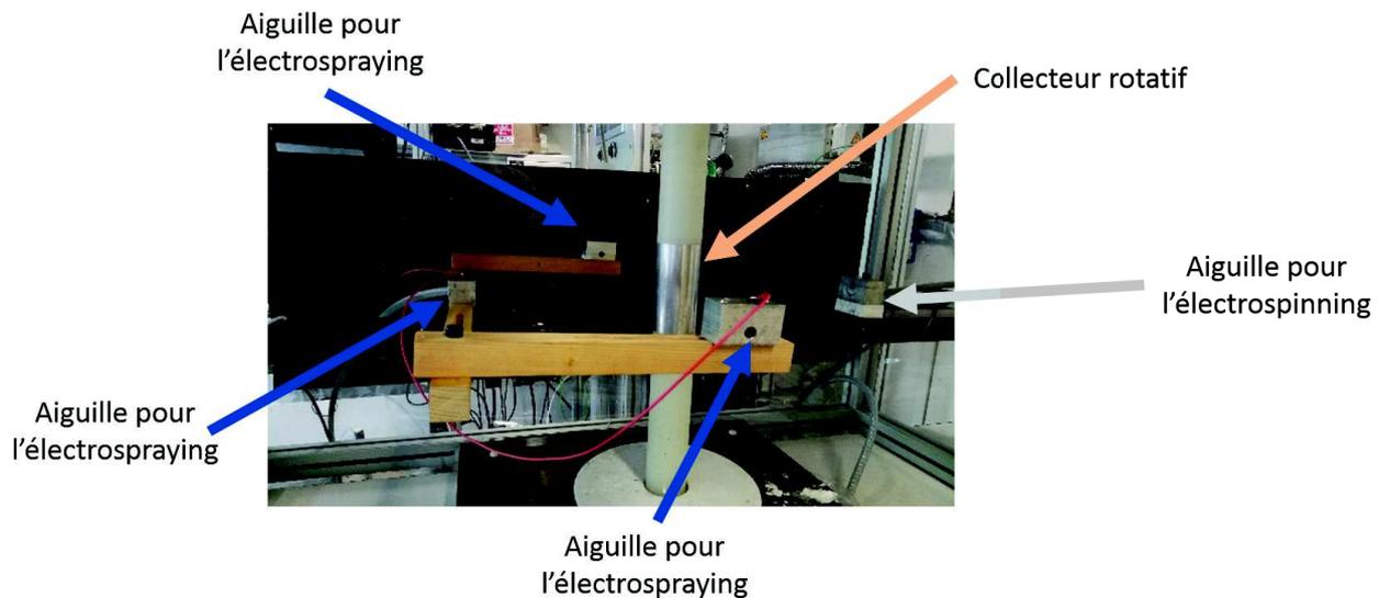
FIGURE 3.25 – Photo du montage comportant les 3 aiguilles pour l'électrospraying et l'aiguille pour l'électrospinning
