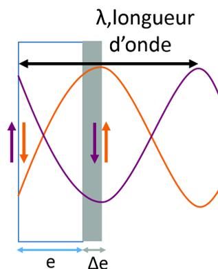
FIGURE 2.49 – Modification de la longueur d’onde  $\lambda$  lorsqu’un film est déposé à la surface du cristal
