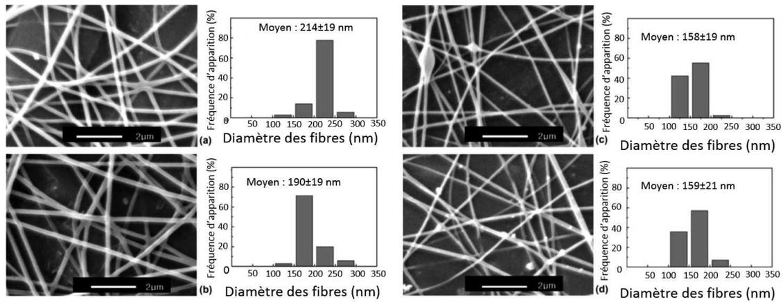
FIGURE 2.10 – Images MEB et diamètre des fibres de PVA obtenues avec ajout de NaCl : a) 0,05%mt de NaCl, b) 0,10%mt de NaCl, c) 0,15%mt de NaCl, d) 0,2%mt de NaCl; d’après Zhang et al. [20].
