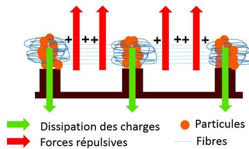
FIGURE 2.34 – Schéma résumant le procédé de structuration lors du co-électrospinning-électrospraying
