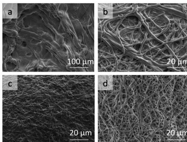
FIGURE 4.20 – Image MEB des fibres obtenues après réticulation dans des solutions aqueuses de  $\text{NaIO}_4$  avec différentes concentrations a) 3%mt b) 5%mt c) 7%mt d) 9%mt.
