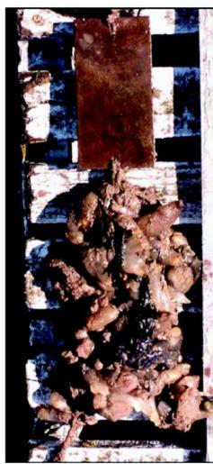
FIGURE 1.23 – Photo de plaques immergées dans un port pendant 12 mois avec en haut une peinture faite de cuivre et de tannins et en bas une plaque contrôle avec une peinture acrylique, d'après Perez et al [106]
