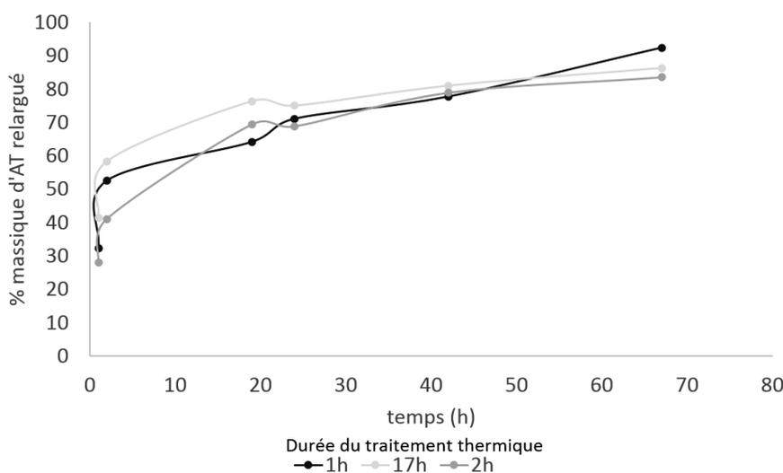
FIGURE 3.9 – AT libéré au cours du temps pour des matériaux PLA+15% d'AT électrospinnés pendant 10 minutes pour différents temps de traitement thermique
