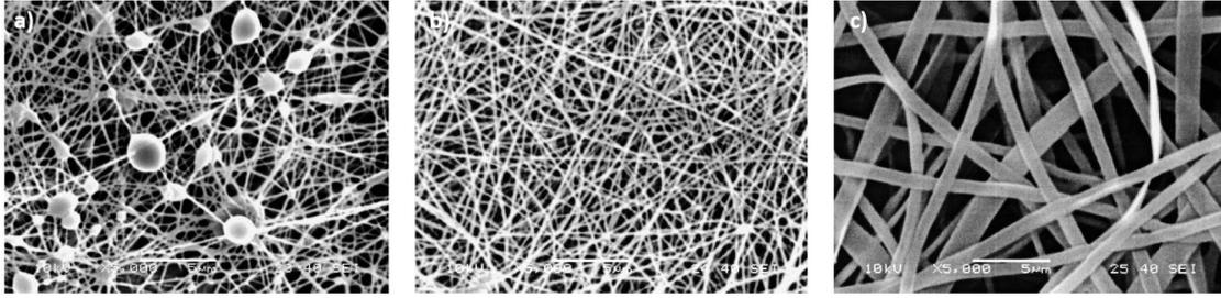
FIGURE 2.4 – Différentes morphologies obtenues pour du PVA : (a) Fibres perlées, (b) Fibres continues (c) Fibres plates ou rubans, d’après Koski et al. [15].
