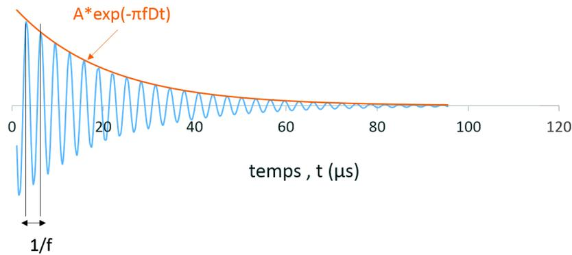
FIGURE 2.50 – Représentation d’une onde amortie (en bleu). L’enveloppe (en orange) de la sinusoïde permet de retrouver le facteur  $D$  puisque son équation est proportionnelle à  $\exp(-\pi fDt)$
