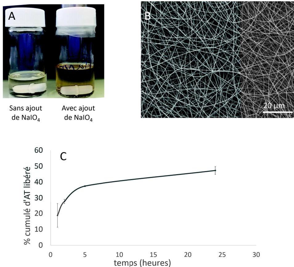
FIGURE 3.10 – A : Photo des solutions de PLA+10% d'AT sans et avec NaIO<sub>4</sub> pour avoir un rapport molaire NaIO<sub>4</sub>/AT de 2. L'oxydation de l'AT provoque un changement de couleur de la solution. B : Image MEB de fibres électrospinnées obtenues à partir de la solution de PLA+10% d'AT contenant du NaIO<sub>4</sub>. Les fibres obtenues sont homogènes. C : Libération de l'AT quand les fibres sont plongées dans l'eau.
