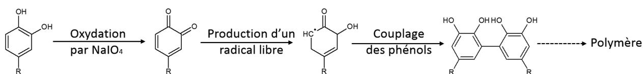
FIGURE 4.18 – Mécanisme possible menant à la production de polymère d'AT
