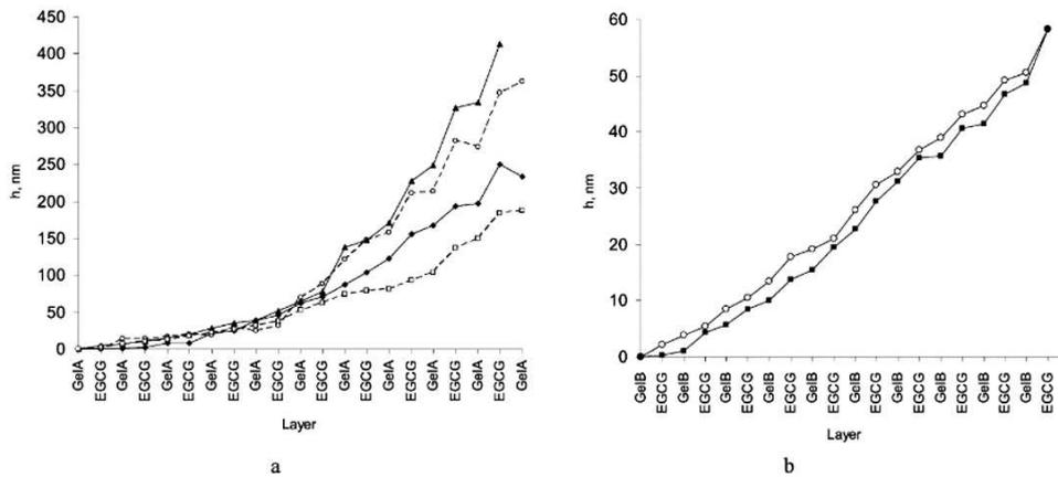
FIGURE 1.13 – Épaisseur des films avec EGCG et la gélatine A (a) et la gélatine B (b) pour différentes expériences indépendantes, d'après Shutava et al. [45].
