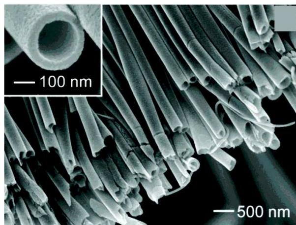
FIGURE 2.18 – Imagerie de microscopie électronique à balayage de fibres creuses de  $\text{TiO}_2$  après carbonisation à  $500^\circ\text{C}$ . Les fibres ont été coupées à la lame de rasoir pour observer leur section ; d’après Li et al. [33].
