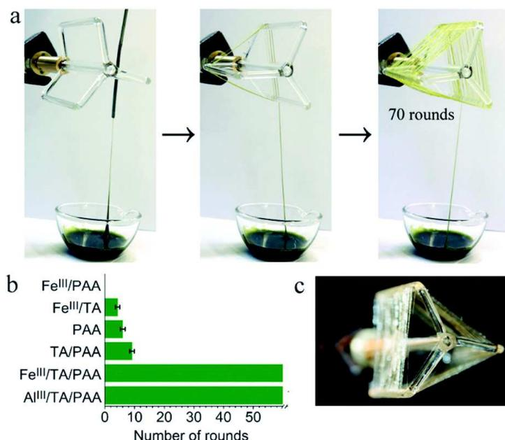
FIGURE 1.16 – A : Fils tissés à partir d’un mélange Fe<sup>III</sup>-AT-PAA. Les fils sont verts dû à des mono-espèce à pH=1. B : Histogramme montrant le nombre de tours pouvant être réalisés pour obtenir du fil avec une combinaison de Fe<sup>III</sup>/Al<sup>III</sup>, AT et PAA. C : Fils transparents et sans couleur obtenus avec Al<sup>III</sup>, d’après Krogsgaard et al. [47]
