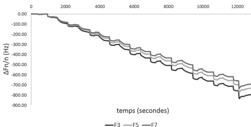
FIGURE 5.11 – Suivi de la construction du film PEI-(LYS-AT)<sub>5</sub> au cours du temps avec en gris les changements pour les 3<sup>me</sup>, 5<sup>me</sup>, 7<sup>me</sup> harmoniques (en gris)
