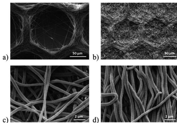
FIGURE 2.26 – Images MEB de fibres de PLA déposées sur un motif en nid d’abeille avec une taille de pore de  $160\ \mu\text{m}$  a) après un court dépôt b) après un long dépôt et après avoir été retiré du collecteur dans de l’isopropanol c) nanofibres de PLA à l’intérieur du nid d’abeille d) nanofibres de PLA sur le mur du nid d’abeille ; d’après Nedjari et al. [41].
