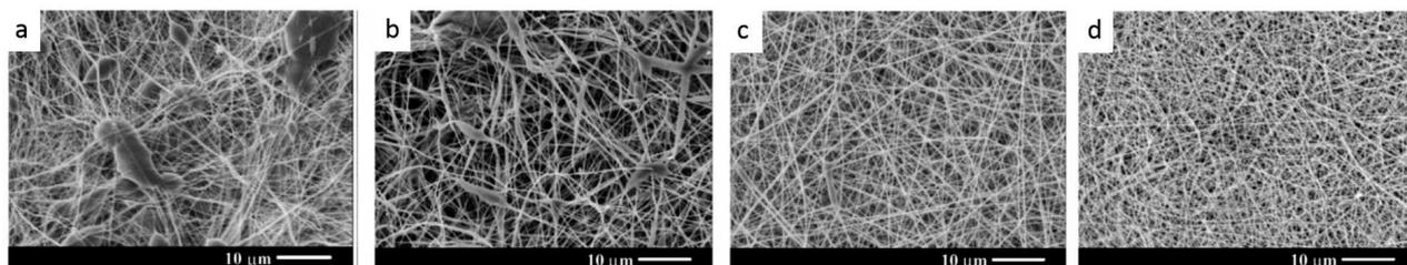
FIGURE 2.11 – Images de microscopie électronique à balayage de fibres électrospinnées de PDLA avec ajout de sel a) sans sel b) avec ajout de 1%mt de  $\text{KH}_2\text{PO}_4$ , c) avec ajout de 1%mt de  $\text{NaH}_2\text{PO}_4$  d) avec ajout de 1%mt de  $\text{NaCl}$ ; d'après Zong et al. [23].
