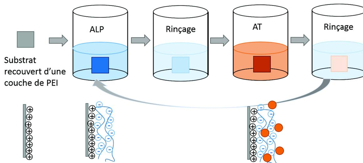
FIGURE 5.1 – Schéma du principe du dépôt couche par couche 'LbL' des films PEI-(ALP-AT)<sub>n</sub>. Le substrat est recouvert de PEI puis est plongé successivement dans une solution de phosphatase alcaline puis est rincé dans du tampon puis est plongé dans une solution d'acide tannique puis rincé de nouveau. Ceci produit une paire de couches. Cette succession d'étapes est répétée n fois pour obtenir un film PEI-(ALP-AT)<sub>n</sub>.
