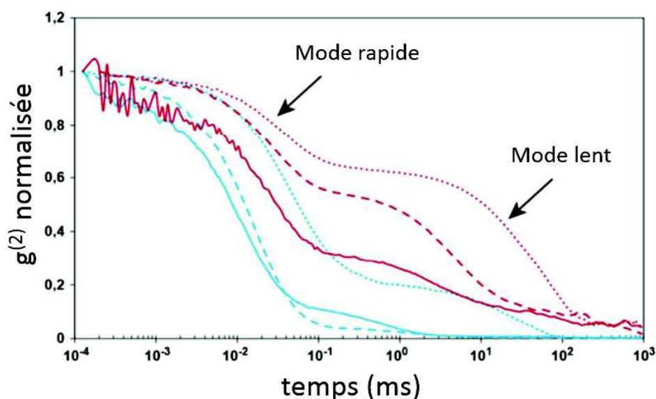
FIGURE 4.17 – Fonction d'autocorrélation  $g^{(2)}$  mesurée par DLS dans l'eau pure (en bleu) et dans le mélange eau-EtOH 37,5-62,5%ms (en rouge) avec  $C_{(AT)}=2\%mt$  (lignes continues),  $C_{(AT)}=10\%mt$  (lignes avec les tirets) et  $C_{(AT)}=35\%mt$  (lignes pointillées).
