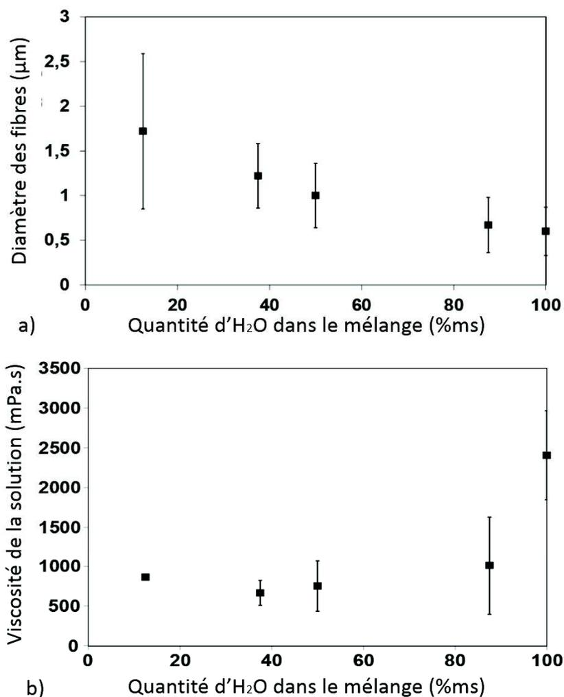
FIGURE 4.14 – a) Evolution du diamètre des fibres en fonction de la concentration en eau dans des mélanges eau-EtOH pour une  $C_{AT}$  de 55%. b) Viscosité de solutions d'AT en fonction de la quantité d'eau dans les mélanges eau-EtOH pour une  $C_{AT}$  de 55%<sub>mt</sub>.
