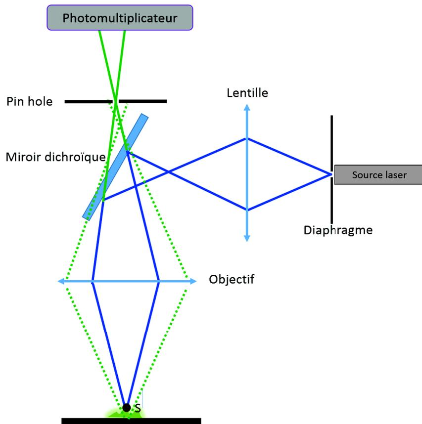
FIGURE 2.55 – Schéma d'un microscope confocal. La ligne bleue représenté le chemin du faisceau laser focalisé qui éclaire l'échantillon. La ligne en pointillés verte représente la fluorescence parasite induite par l'éclairement de l'échantillon. Elle est arrêtée grâce au pin hole et seule la fluorescence émise par le point éclairé par le laser est observée (ligne verte continue).
