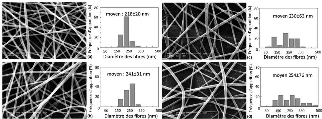
FIGURE 2.12 – Images de microscopie électronique à balayage de fibres électrospinnées de PVA et répartition des diamètres pour des fibres de PVA en modifiant la tension appliquée (a) 5 kV ; (b) 8 kV ; (c) 10kV (d) 13 kV ; d’après Zhang et al. [20].
