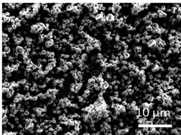
FIGURE 4.13 – Images MEB de particules obtenues avec une solution en AT dans l'éthanol à 100 mg/mL, la concentration limite de solubilité de l'AT dans l'EtOH.
