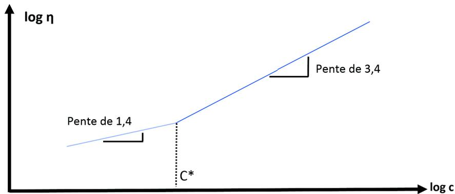
FIGURE 2.42 – Courbe caractéristique de l'influence de la viscosité en fonction de la concentration. Pour une concentration à  $C^*$ , la solution est en régime dilué. Au delà de  $C^*$ , la solution est en régime semi-dilué.
