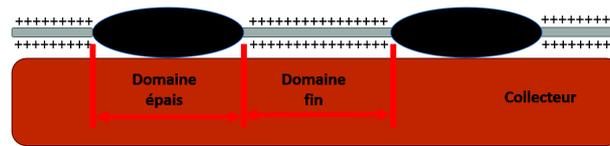
FIGURE 2.22 – Schéma du dépôt de fibre de PCL sur le collecteur.
