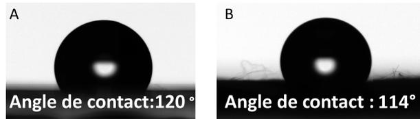
FIGURE 3.13 – Images de mesure d'angle de contact pour A : des fibres de PLA seul, B :des fibres PLA + 15% d'AT
