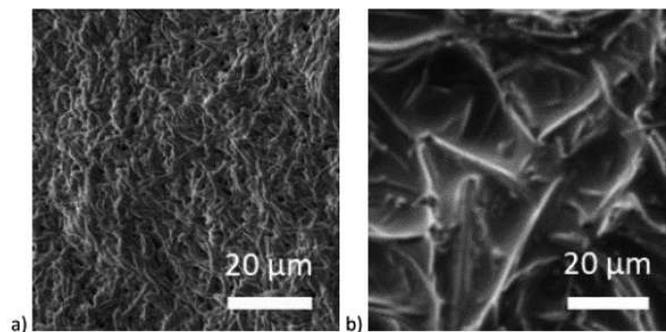
FIGURE 4.19 – Image MEB des fibres obtenues juste après réticulation a) dans une solution aqueuse de  $\text{NaIO}_4$ , b) dans une solution de nitrate de fer III.
