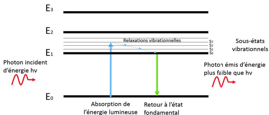
FIGURE 2.53 – Diagramme du processus de fluorescence
