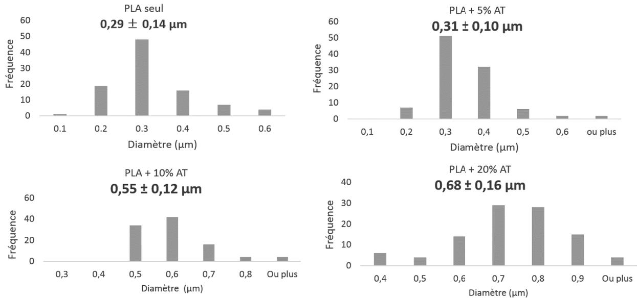
FIGURE 3.5 – Diamètre moyen et répartition de diamètres de fibres pour au moins 100 fibres obtenues à partir de solutions PLA et AT.
