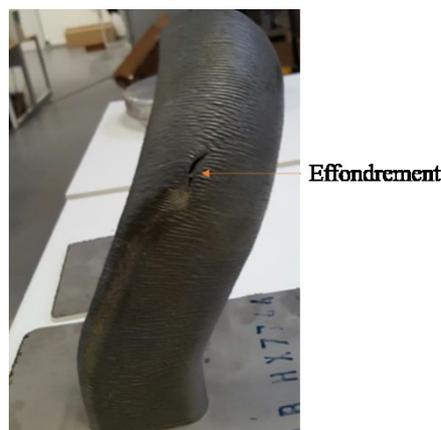
Figure 1-10 Pièce DML présentant un effondrement : le manque de fusion se propage sur plusieurs cordons et laisse une pièce présentant une fissuration.
